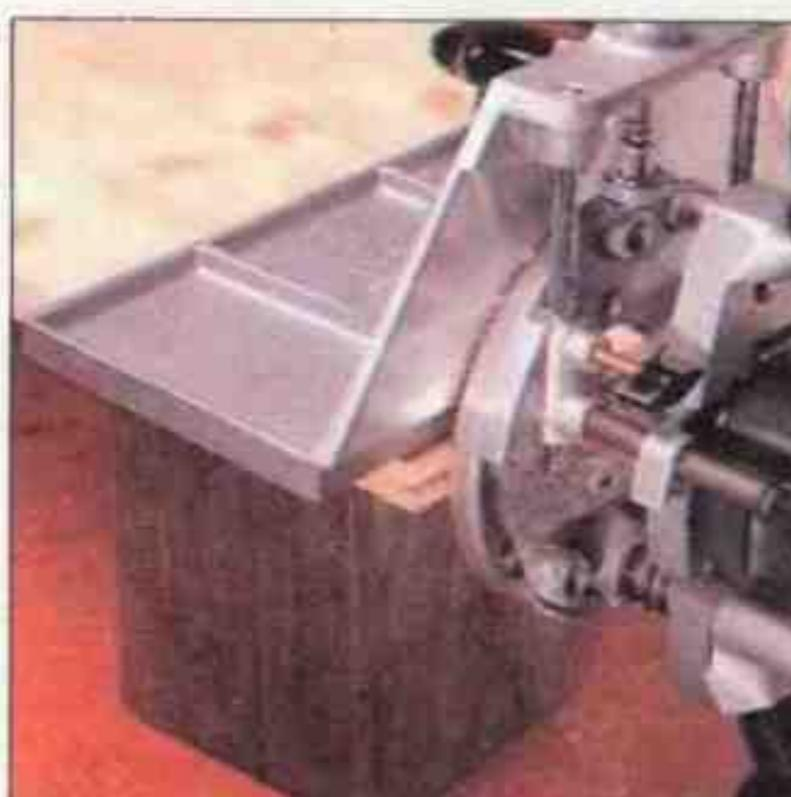
Благодаря широкому упору фреза перемещается параллельно к плоскости заготовки и перпендикулярно к ее кромке.
