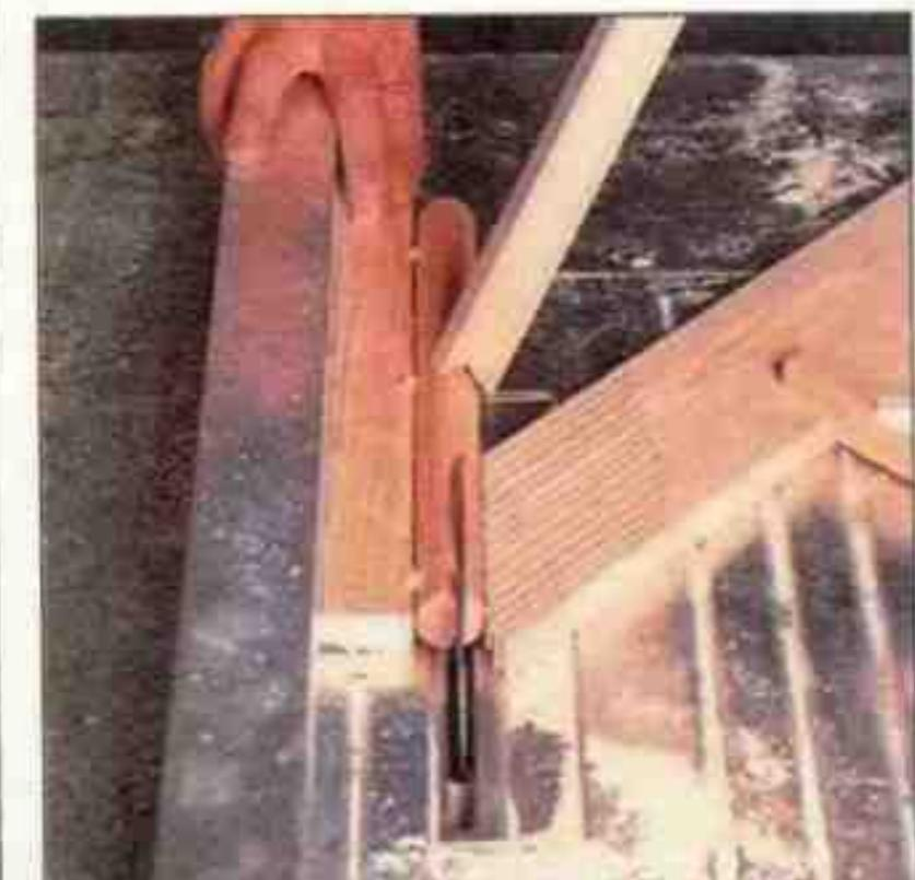
У круглого стержня надежные направляющие: пружина-гребенка и продвигающая планка плотно прижимают его к параллельному упору.
