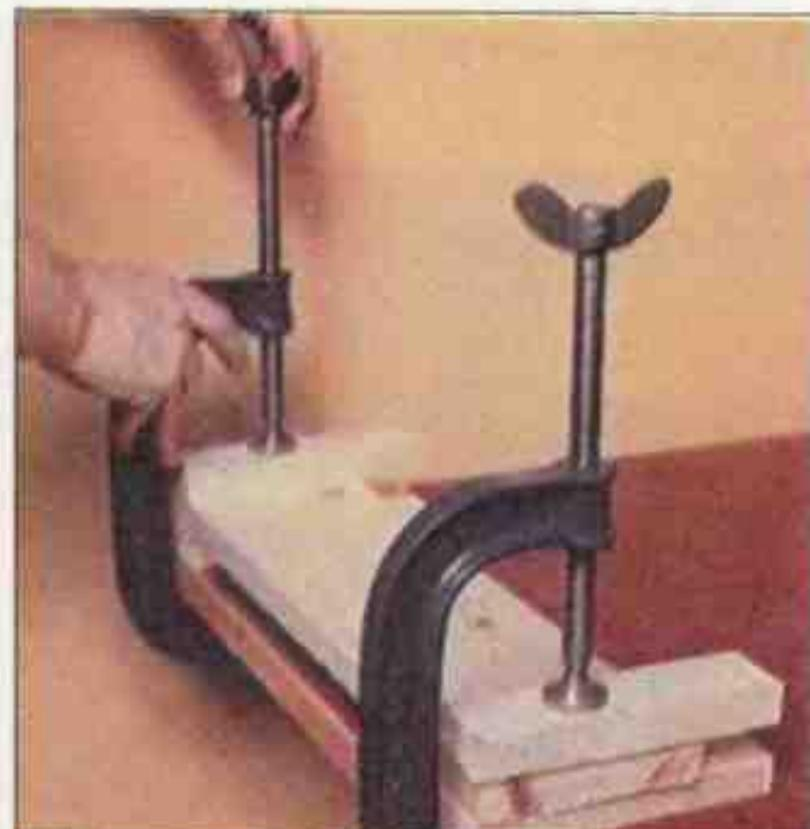
Подложите под деталь подходящих размеров деревянный брускок: он предотвратит расщепление краев просверленного отверстия с нижней стороны детали.
