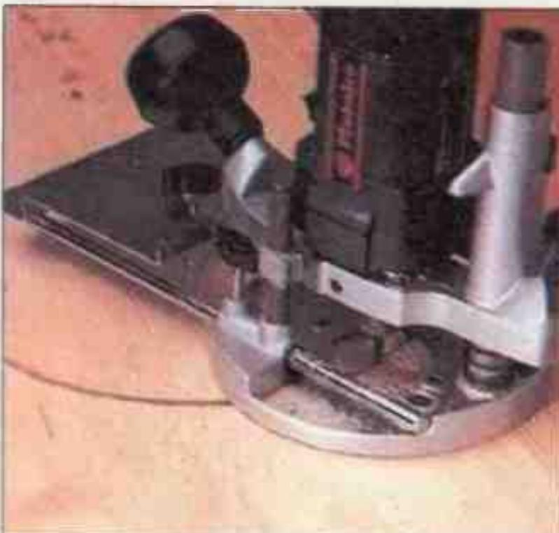
Фрезе задает направление вставленный в параллельный упор и затем вбитый в дерево центрирующий штифт. Так формируются круглые и дугообразные пазы.
