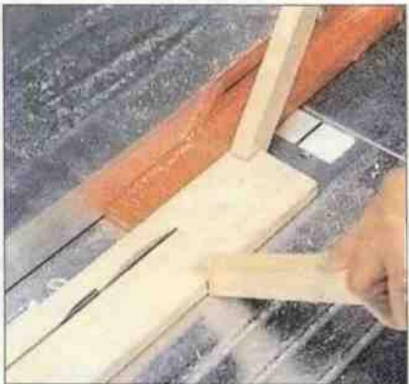
**Фиксировать положение детали в процессе распиливания лучше двумя стержнями: один продвигает деталь, другой прижимает ее сбоку к направляющей.**
