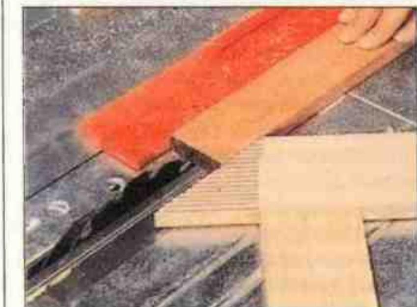
Скошенная "гребенка" на конце широкой планки прижимает деталь к параллельному упору.
