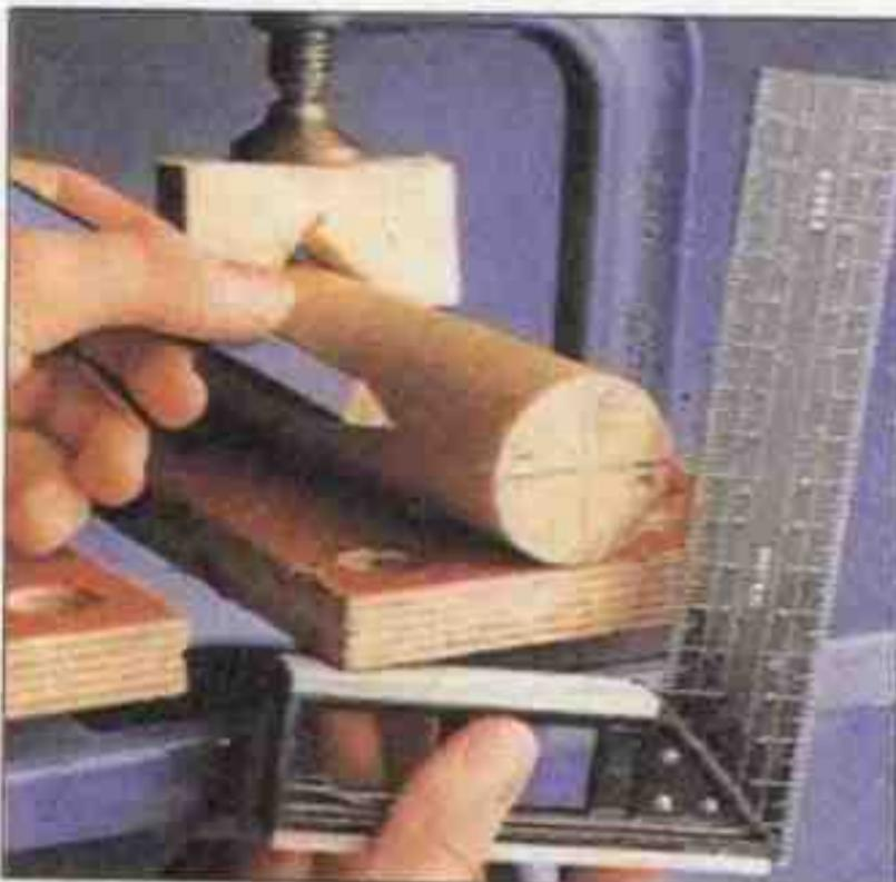
Только жестко зажатый кругляк удаётся просверлить с высокой точностью. Проконтролируйте положение сверла и детали.
