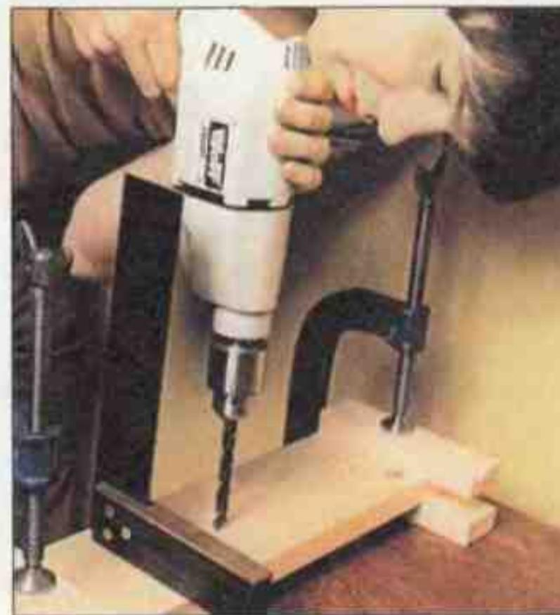
Используя столярный или чертежный угольник, можно проконтролировать положение сверла по отношению к поверхности детали.
