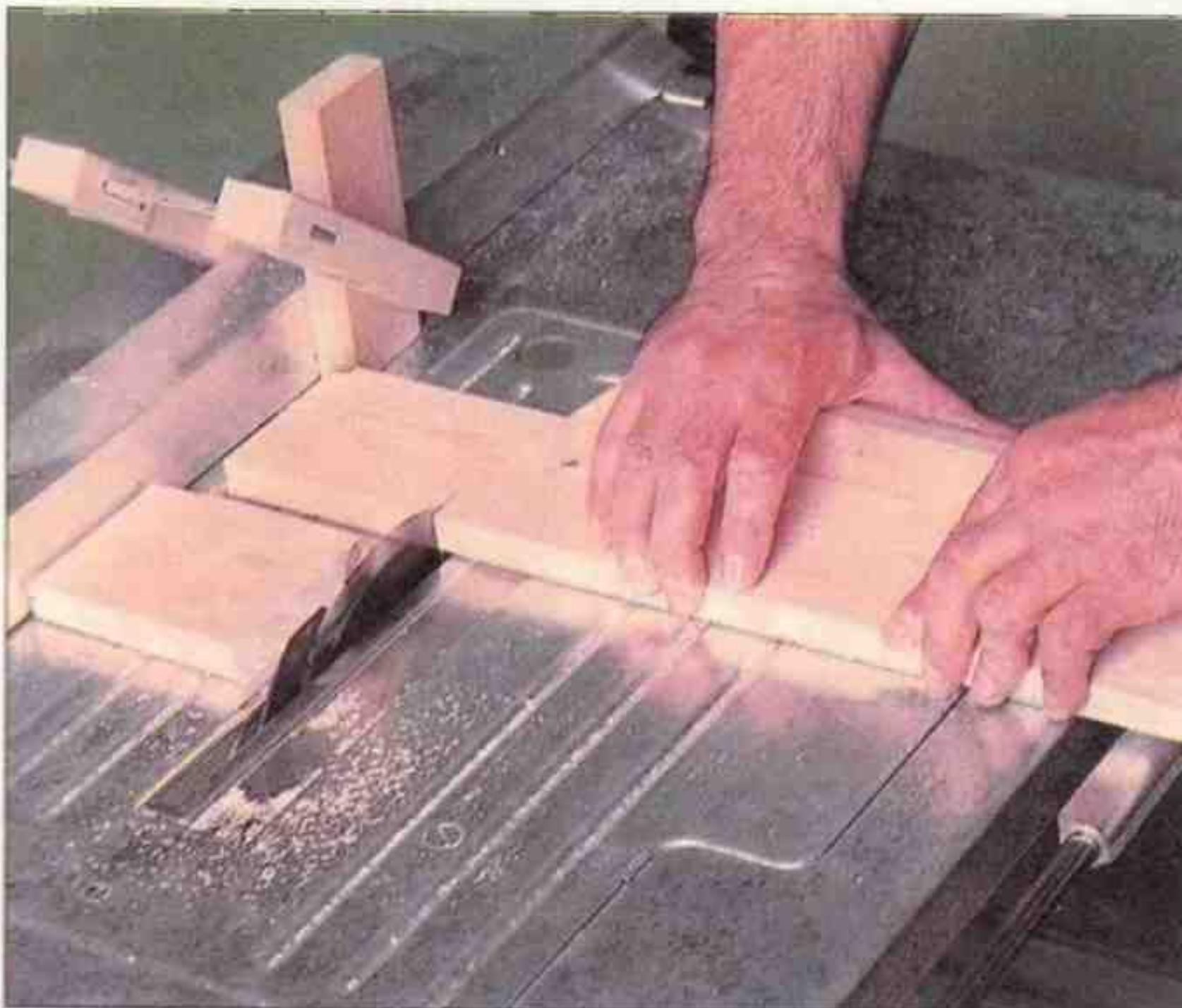
Если нужно распилить заготовку на несколько небольших частей равной длины, то не обязательно делать предварительную разметку: достаточно на нужном расстоянии от пилящего диска закрепить упор на параллельной направляющей. Упор надо устанавливать перед диском, а не рядом с ним!
