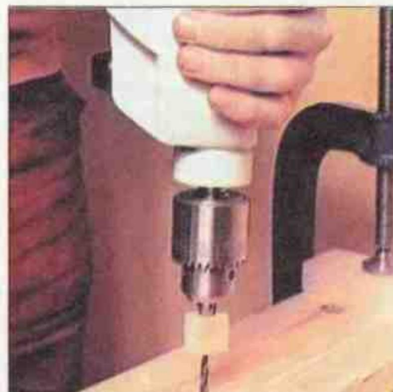
Установленная на сверло колодка (небольшой деревянный кубик) ограничивает глубину врезания. Такой ограничитель необходим при сверлении глухих отверстий определенной глубины.
