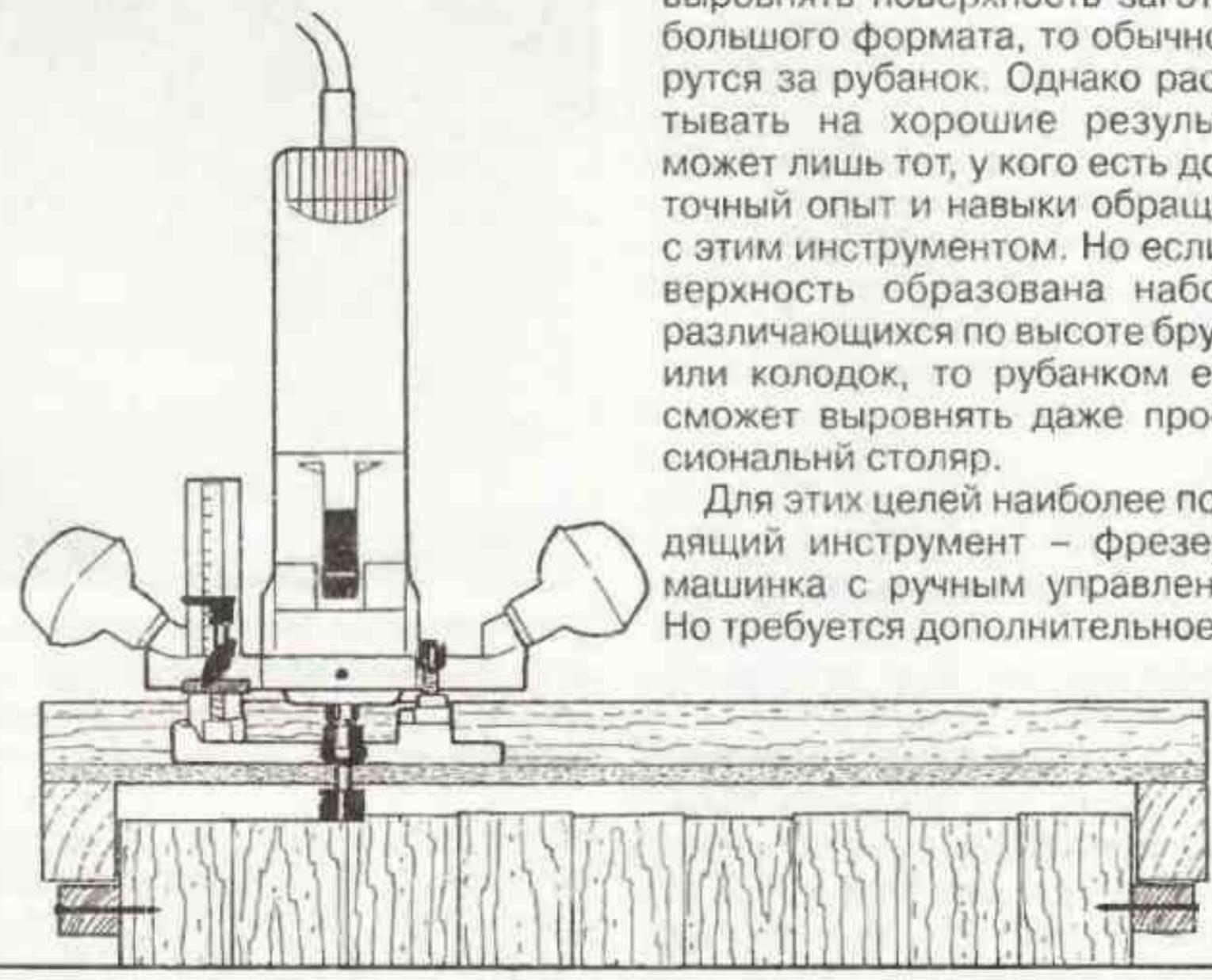
Фрезерная установка в разрезе: направляющие "салазки" для фрезерной машинки опираются на бруски, закрепленные с боков обрабатываемой детали. Режущие кромки фрезы выравнивают поверхность.
