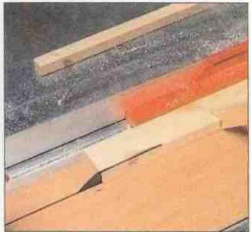
**Пластина из фанеры препятствует попаданию в щель между пилящим диском и рабочим столом тонких обрезков.**
