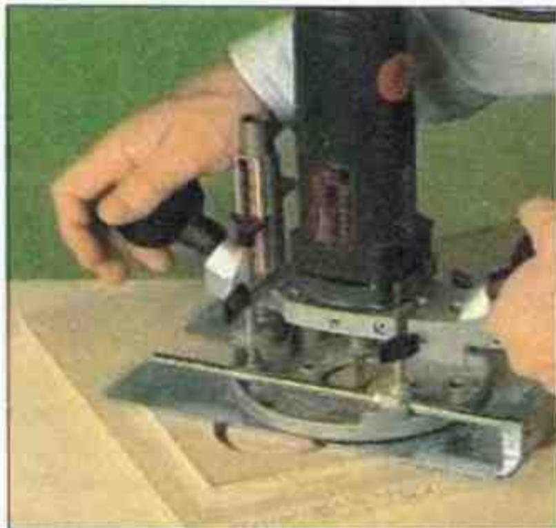
У диска, вырезанного пазовой фрезой, кромка прямая. Если же самое сделать закруглительной фрезой, то диск приобретает выпуклую, закругленную кромку.
