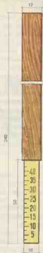
32. Деревянный пестик, применяемый для определения густоты мастики
