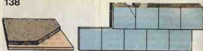
138. Нанесение раствора на плитку при облицовке стен
