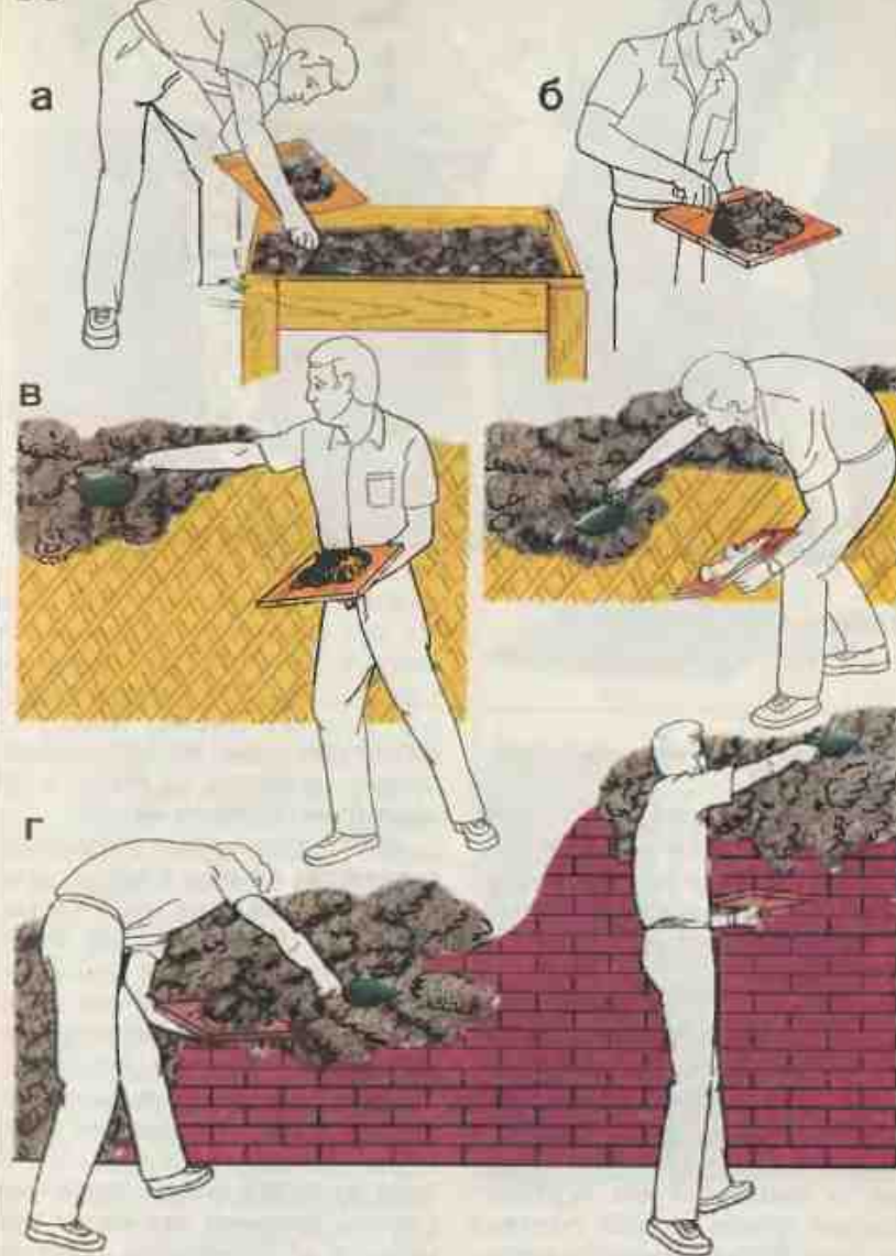
55. Нанесение раствора на стену кельмой
