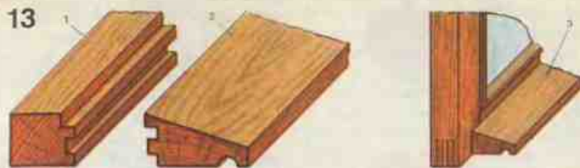
13 Устройство и установка нового отлива 1 — брус; 2 — отлив; 3 — установленный отлив
