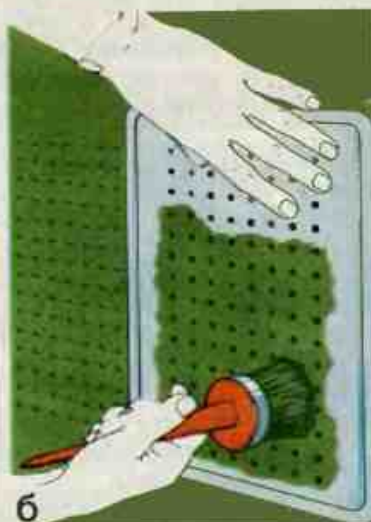
97. Рельефная фактура, получаемая с помощью кисти
