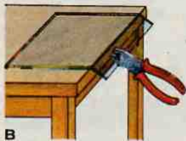
111. Ломка стекла а — руками; б — стеклорезом; в — плоскогубцами
