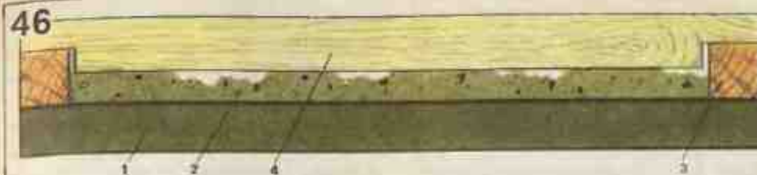
46. Разравнивание раствора малкой по деревянным маякам
