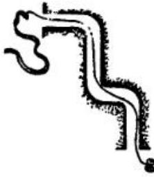
Отвернуть перекрытый с силой водопроводный вентиль, у которого сорваны грани шпинделя, иногда не удается даже газовым ключом — слишком малы размеры захвата. Но если сперва захватить шпиндель пассатижами, а уже пассатижами сжать газовым ключом, усилие, передаваемое на шпиндель, резко возрастет.
