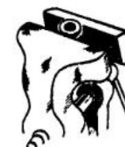
Просверлить в металлическом прутке или в трубке радиальное отверстие весьма непросто. Особенно если вы пытаетесь сделать это ручной дрелью. Облегчить задачу можно таким образом: в деревянном бруске просверлить отверстие соответствующего диаметра, вставить туда трубку и спокойно сверлить ее через бруск, не опасаясь, что сверло соскользнет.
