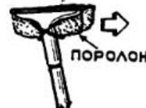
Чтобы быстро освежить покрытый побелкой потолок, можно почистить его куском поролона, привязанным к конической насадке включенного пылесоса. Снятый поролоном верхний слой побелки вместе с пылью тут же засасывается в пылесос.
