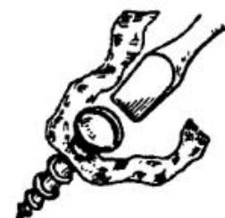
Среди способов заземления винта или шурупа в труднодоступном месте есть и такой: шуруп пропускается через кусочек клейкой ленты, концы которой фиксируются на створке.
