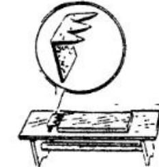
Для фиксации на верстаке досок при ручном строгании можно использовать стопор-держатель, зубцы которого погружаются в древесину, надежно удерживаю обрабатываемую деталь в нужном положении. Стопор изготавливается из стальной полосы толщиной 3–4 мм и помещается в специальном пазе верстака. После окончания стопор снимается или опускается до упора.
