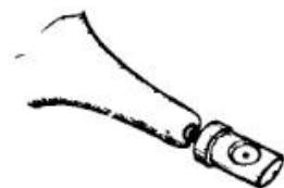
Распылительная головка от использованного аэрозольного баллона вставленная в резиновую грушу превратит ее в одноразовый пульверизатор для жидкостей
