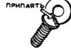
Винты с крыльчатой головкой намного удобнее обычных, если речь идет о зажимных или часто разбираваемых устройствах. Сделать такой винт можно, вставив в шлиц шайбу подходящего размера и закрепив ее пайкой.
