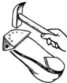
**РАЗМЕЧАЯ НА ПОДОШВЕ ЛЫЖНОГО БОТИНКА ГНЕЗДА ДЛЯ ШИПОВ ЖЕСТКОГО КРЕПЛЕНИЯ, СМОЧИТЕ ПОДОШВУ У носка ботинка ВОДОЙ, НАЛОЖИТЕ на нее поточнее КРЕПЛЕНИЯ И УДАРЬТЕ 2—3 раза МОЛОТКОМ ПО ОСНОВАНИЯМ ШИПОВ. На подошве останутся заметные вмятины от шипов в тех местах, где должны находиться гнезда.**
