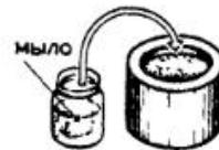
Чтобы при окраске масляной краской получить матовую поверхность, нужно в краску добавить раствор 40 процентного хозяйственного мыла из расчета 1 кусок на 3 литра краски. Мыло строгают стружкой, заливают водой (чтобы она слегка покрывала) и нагревают, пока оно не растворится. Затем, помешивая, добавляют в краску.
