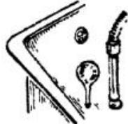
Прежде чем начинать разбирать слий ванной, чтобы достать случайно попавшее туда кольцо, сережку, испробуйте zunächst другой способ. Заткните тряпкой отверстие перелива и попытайтесь вытащить утерянную вещь вместе с воздухом с помощью пылесоса. Остатки воды в сливе нужно предварительно отсосать грушевиной-спринцовкой
