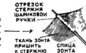
Сломанный наконечник стержня можно заменить отрезком использованного металлического стержня шариковой ручки.
