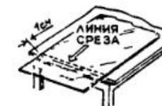
Тем, кому предстоит работать со стеклом, напоминаем: ломать стекло по прорези, сделанной алмазом или стеклорезом, нужно положив лист на стол таким образом, чтобы линия прореза не доходила до края стола примерно на сантиметр. Давите вниз. В особенности это правило следует соблюдать при разке толстого стекла.
