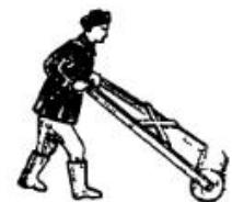
Пользуясь ручным катком, уплотняющим снег, вы избавитесь от частых расчисток садовых дорожек. С укатанных дорожек снег сдувается ветром, в то время как траншеи, прокопанные лопатой, постоянно заносятся. Катком удобно притягивать приствольные круги деревьев, проводить снегозадержание. Изготавливается он из дубового кряжа, масса около 20 кг.
