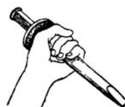
Фанерный и резиновый диски с отверстием посередине, надетые на зубило или шлямбур, предохранят вашу руку от возможных ударов молотком.
