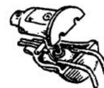
Дополнительный выключатель на шланге пылесоса повысит удобство, оперативность работы и даст экономию электроэнергии. Имея выключатель под рукой, хозяин будет чаще выключать пылесос, когда что-то переставляет и убирает. Провод с вилкой прикрепляется к шлангу липкой лентой, на корпусе пылесоса устанавливается розетка.
