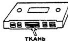
Устройство для очистки звукоизлучающей головки магнитофона нетрудно сделать из старой магнитофонной кассеты, вставив в нее вместо пленки узкую полоску мягкой ткани. Поработав 30—40 секунд в рабочем «автоспроизведении», такая кассета хорошо очистит головку.
