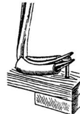
Чтобы винт, головка которого скрыта за преградой, не вращался вместе с затягиваемой на нем гайкой, нужно накинуть на него несколько витков нитки или тонкой проволоки и слегка натянуть концы. За счет трения винт хорошо удерживается на месте. Концы нити после затяжки гайки можно обрезать.
