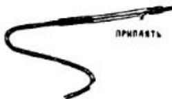
Конец оголенной проволоки припаяйте к на jakiщнику использованного стержня авторучки, а второй ее конец — к одножильному проволу в полизиэтиленовой изоляции. Проволоку введите внутрь стержня с таким расчетом, чтобы туда вошла и часть изолированного провода.
