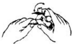
Чтобы хорошо отшлифовать наружной бумагой круглый деревянный или пластмассовый стержень, сделайте простое приспособление: в прямоугольном деревянном бруске просверлите отверстие, соответствующее диаметру стержня, а потом распишите брусков на две равные части.
