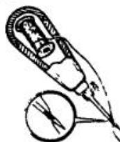
При сборке мебели нередко приходится завинчивать большое число шурупов в подготовленные отверстия. Работу можно ускорить, если закрепить в коловороте нужное жало, взятое из набора отверток со сменными жалами.
