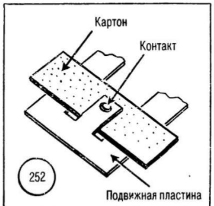
▲ Если ваш холодильник вышел из строя из-за подгорания контактов теплозащитного реле (например, РТП-1) и нет возможности приобрести новое реле, можно зачистить контактные на старом (рис. 252). Для этого от движущей контактной пластины отпаяйте провода, удалите застывшие клейки и снимите пластину. Надфилом и наждачной бумагой зачистите контактные, затем болтом М3 укрепите пластину на прежнем месте и припаяйте провода.
