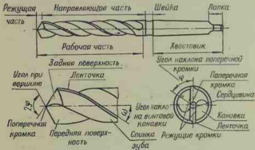
Рис. 20. Элементы и геометрия спирального сверла
