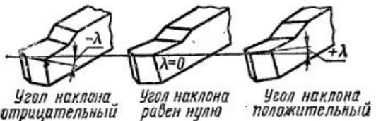
Рис. 4. Угол наклона главной режущей кромки
