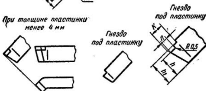
Рис. 7. Конструкция резца с углом врезки пластиинки в стержень 0°
