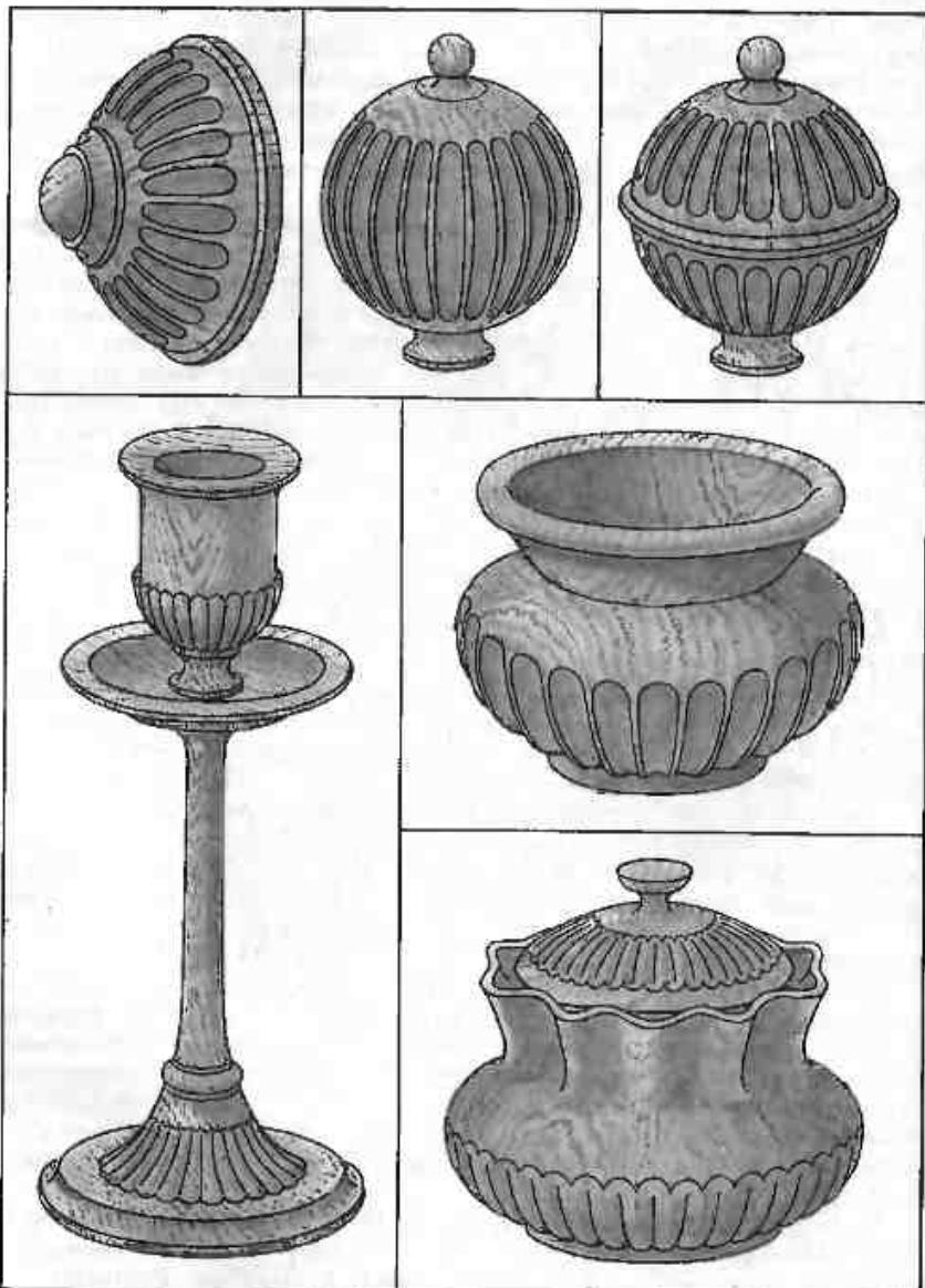
поверхности заготовки не останется нетронутой древесины. Такая поверхность нуждается в повторной токарной обработке только в местах, свободных от фрезерования.
