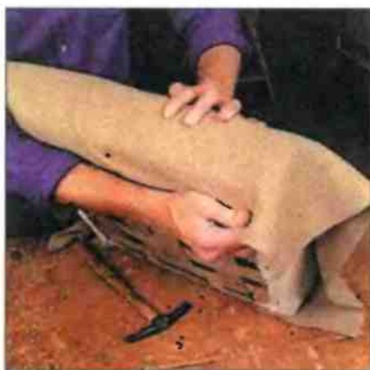
1. Обивочной тканью покройте набивку и прибейте края, не доходя примерно 25 мм до углов.
