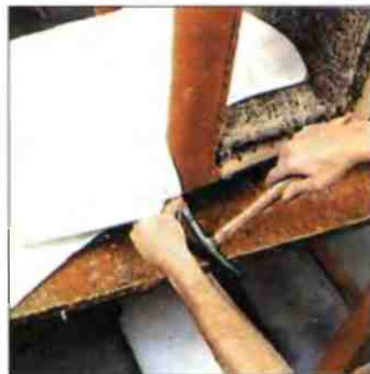
2. Углы ткани аккуратно загните внутрь, подтяните вплотную к подлокотнику и прибейте гвоздями под натяжкой.
