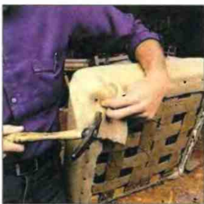
4. При обработке закругленного угла конец ткани потяните вниз. Лишнюю ткань равномерно распределите по обе стороны.
