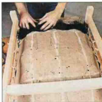
1. Сначала набивочным материалом заполняют углубления по краям рамки.
