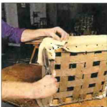
5. Тонкую ткань уложите складками, на толстой сделайте два V-образных надреза, затем сложите дважды.
