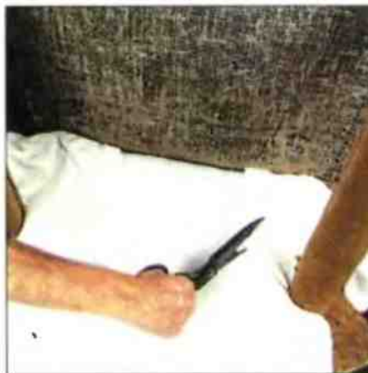
3. Раскрой для задней опоры: ткань с угла надрезать до угла опоры, после чего завернуть внутрь.
