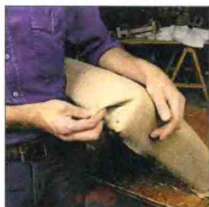
6. Сначала уложите одну складку и осторожно потяните ее вниз параллельно углу. Вторую складку потяните в другую сторону.
