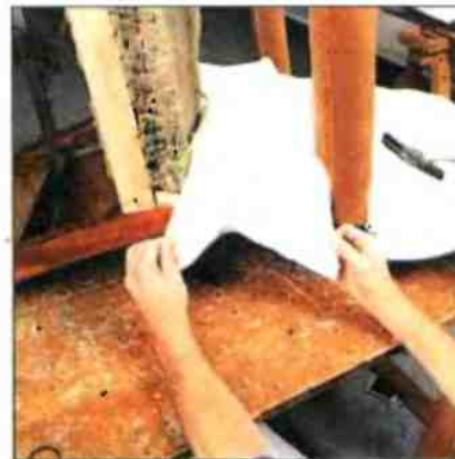
4. Углы ткани натягивают туго вокруг опоры и прибивают к нижней стороне перекладки. Следите, чтобы на ткани не было складок.
