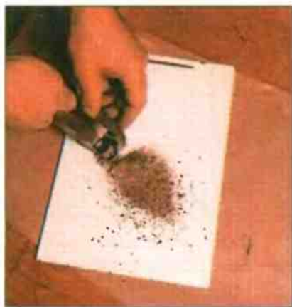
1. Карнаубский воск – твердая древесная смола, при добавлении в небольших количествах в мебельный воск придает последнему прочность.
