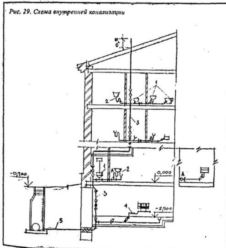
1, гидравлических затворов 2, внутренней канализационной сети 3, выпусков 5, местных установок для очистки 4 и перекачки сточных вод. Выпуски представляют собой трубы, соединяющие стояки с дворовой канализацией, которая служит для отвода сточных вод из здания в уличную сеть.
