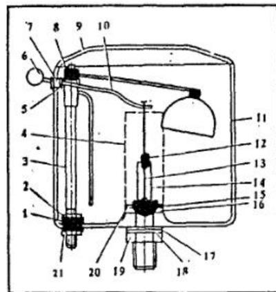
Рис. 83. Бачок с нижней подводкой трубы: 1, 22 — резиновые прокладки и металлические шайбы; 2, 5, 21 — контргайки; 3 — стойка; 4 — перелив; 6 — ручка; 7 — втулка механизма спуска; 8 — вертикальный поплавковый клапан; 9 — крышка бачка; 10 — рычаг; 11 — корпус бачка; 12 — втулка; 13 — тяга; 14 — дуга; 15 — груша; 16 — резиновая прокладка седла; 17 — резиновая прокладка; 18 — металлическая шайба; 19 — гайка седла; 20 — седло
