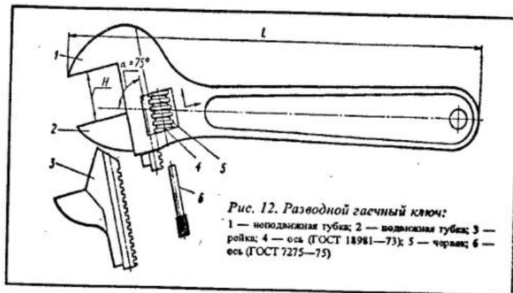
Рис. 12. Разводной гаечный ключ:
