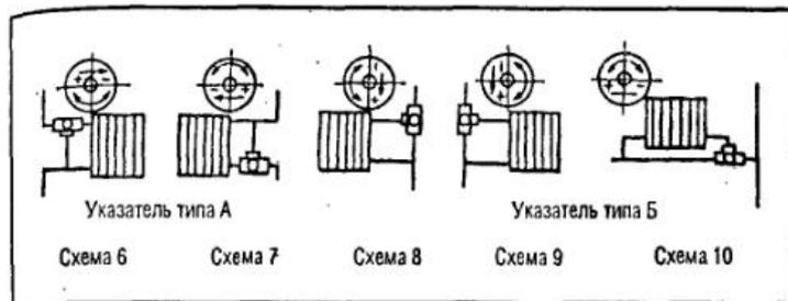
Рис. 35. Порядок установки трехходового крана (подача теплоносителя слева)
