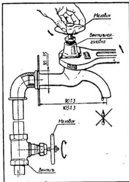
Рис. 41. Заворачивание маховика вентиля и вывертывание вентиляльной головки
