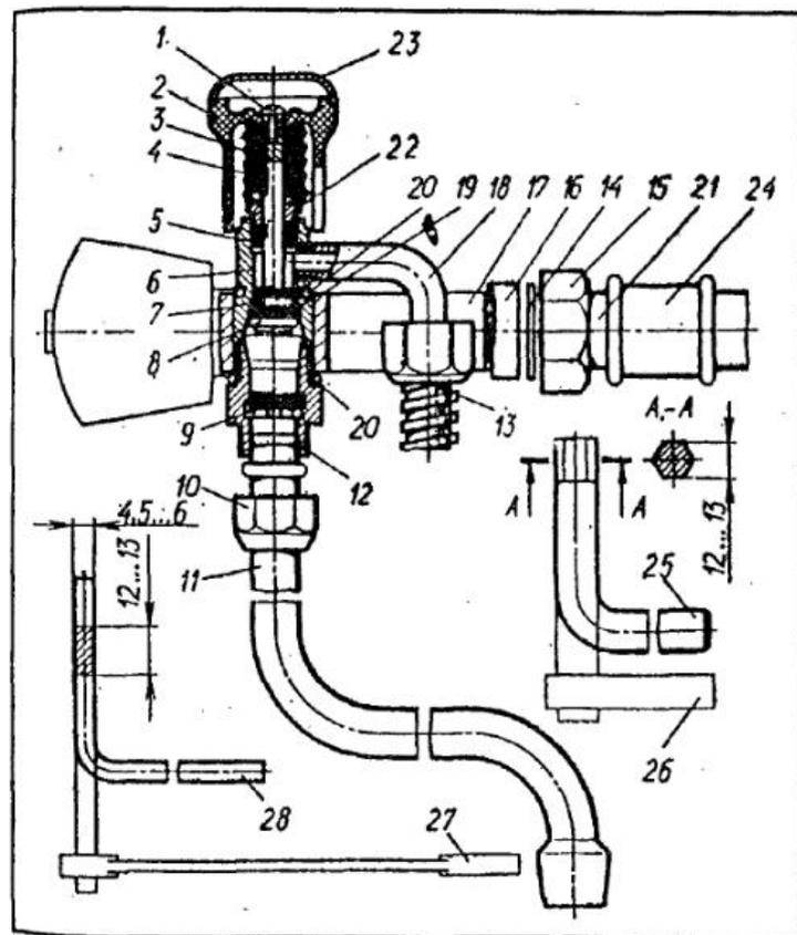
Рис. 66. Разрез смесителя с кнопочным вертикально расположенным переключателем:
