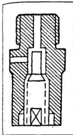
Рис. 36. Кран для выпуска воздуха из нагревательных (отопительных) приборов
