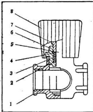
Рис. 32. Кран регулирующий трехходовой с пробковым регулирующим устройством КРТП-20 универсальный:
