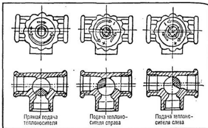
Рис. 33. Схема работы трехходового крана
