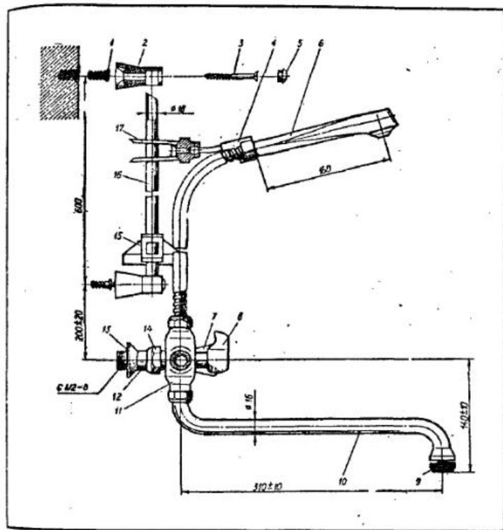
Рис. 60. Смеситель с переключателем золотникового типа и штангой для перемещения душевой сетки вместе с гибким шлангом:
