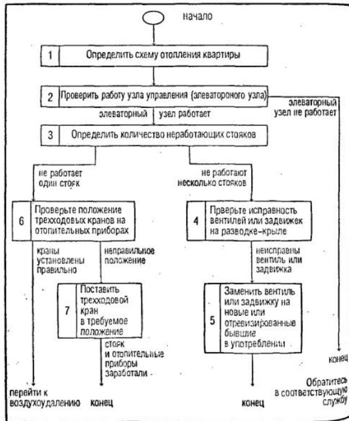
Рис. 31. Алгоритм проверки общих узлов системы отопления
