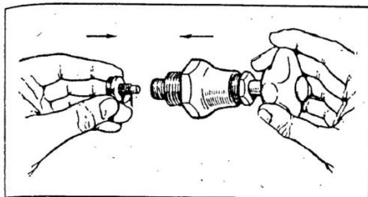
Рис. 44. Фиксация клапана с прокладкой в штоке
