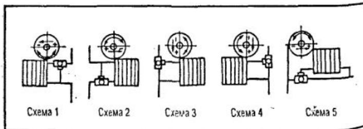
Рис. 34. Порядок установки трехходового крана (подача теплоносителя справа)
