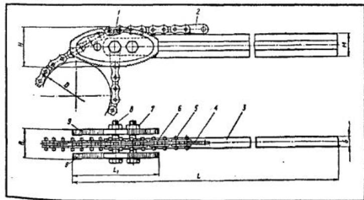
Трубный цепной ключ (рис. 15) представляет собой рукоятку 3, к одному из концов которой болтами 8 с гайками 7 прикреплены две ще-
