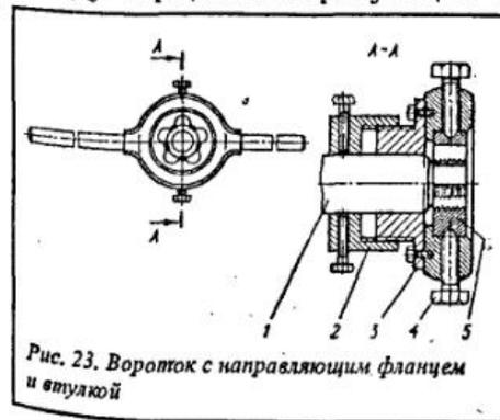
Рис. 23. Вороток с направляющим фланцем и втулкой
