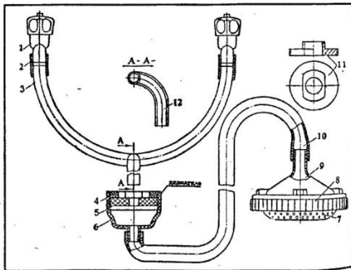
Рис. 71. Простейший заводской смеситель универсального назначения:
