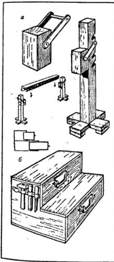
Рис. 10. Козлы, ящик для инструментов
