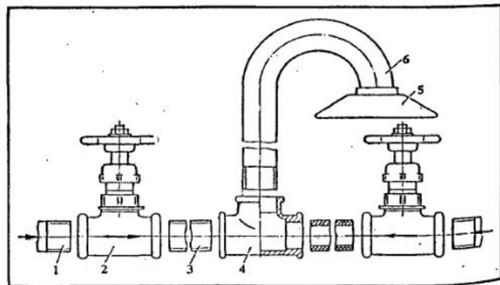
Рис. 68. Самодельный смеситель для душа со стационарной душевой трубкой и сеткой:
