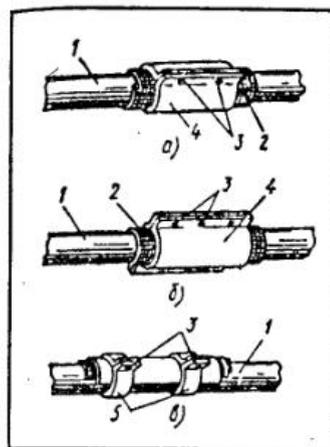
Рис. 38. Заделка местных повреждений стальных трубопроводов: а, б — бандажами с двух- и односторонними стяжками; в — хомут с накладкой; 1 — трубопровод; 2 — прокладка; 3 — болты с гайками; 4 — бандаж; 5 — хомуты
