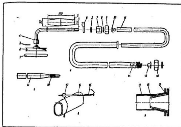
Рис. 59. Ремонт гибкого шланга с душевой сеткой:
