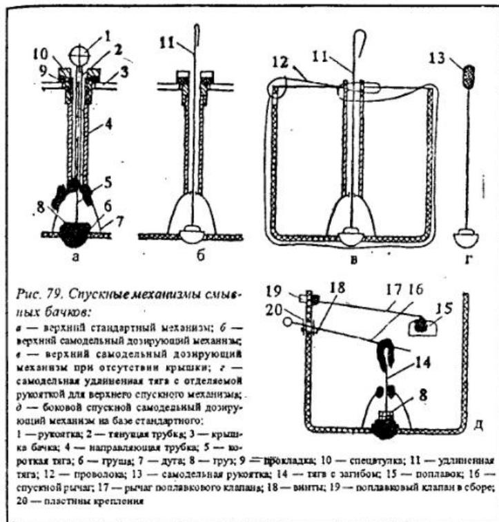
Рис. 79. Спускные механизмы смывных бачков:
