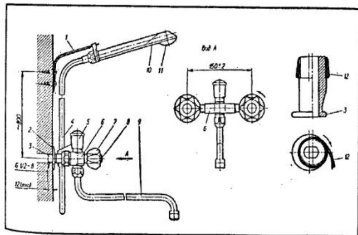
Рис. 65. Общий вид смесителя с кнопочным вертикально расположенным переключателем:
