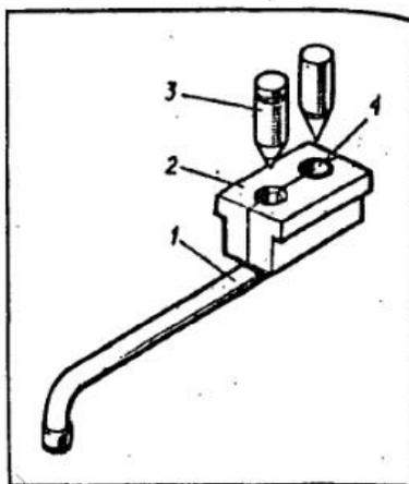
Рис. 57. Приспособление для развальцовки трубок:
