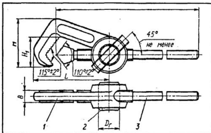
Рис. 14. Ключ трубный накидной
