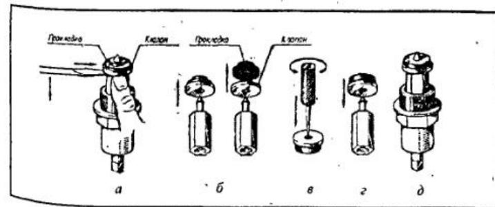
Рис. 51. Пооперационные действия по замене изношенной прокладки в клапане вентиляльной головки с возвратно-поступательным движением шестигранного шпинделя
