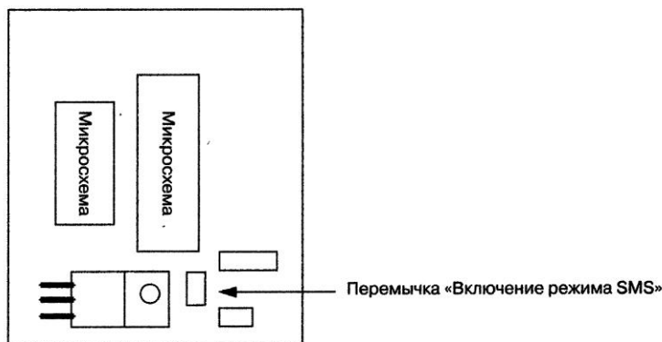
Рис. 3.11. Расположение элементов на плате блока контроля и управления
