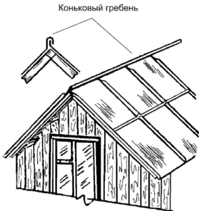
Рис. 7.9. Устройство конька
