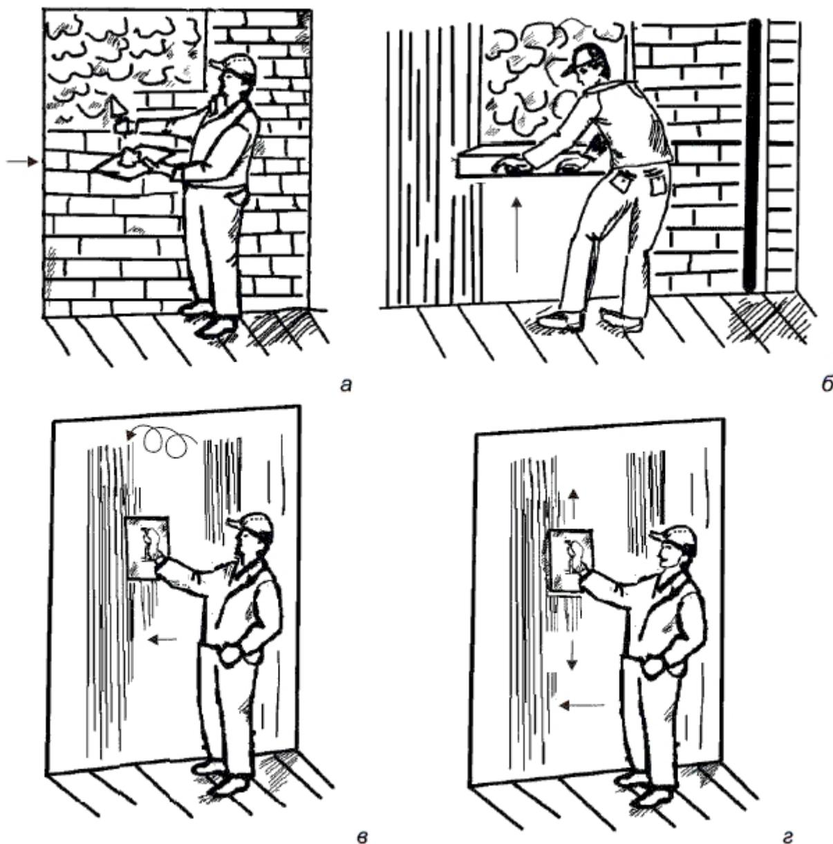
Рис. 11.2. Оштукатуривание поверхности стен:
