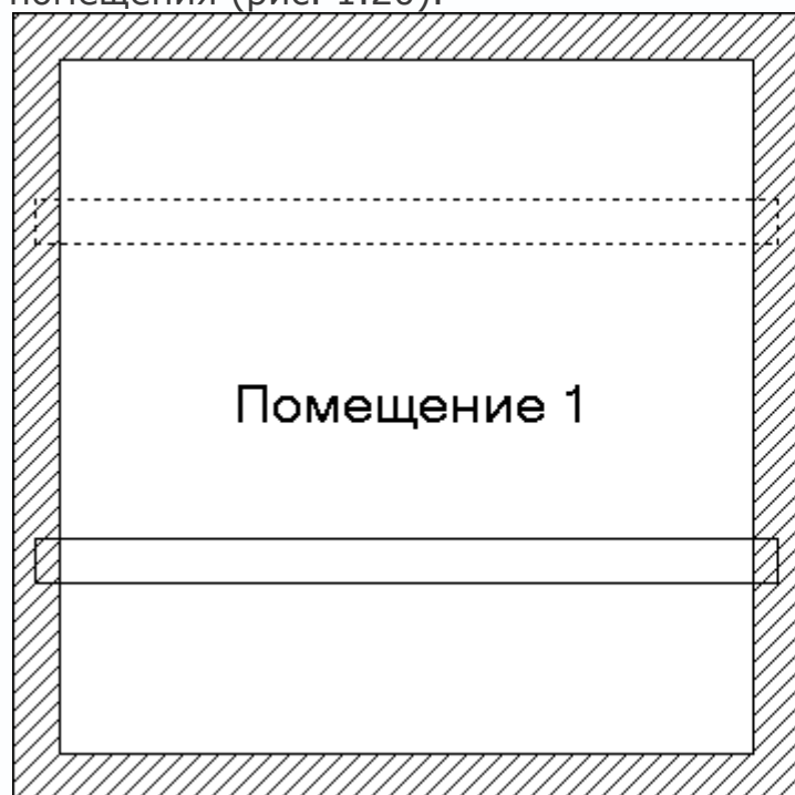
Рис. 1.20. Изображение подбалки и надбалки на чертеже (слева) и в трехмерной модели (справа)
