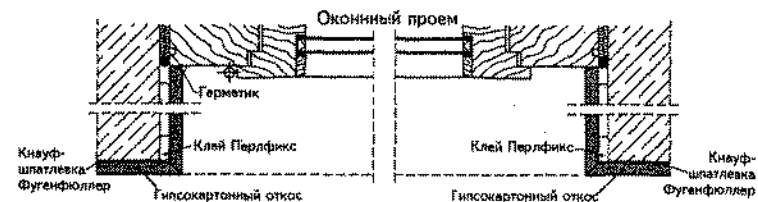
Рис. 5.65. Пример обустройства откоса оконного проема с использованием гипсовых профилированных конструкций
