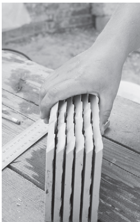
Рис. 2.38. Проверка ровности плиток
