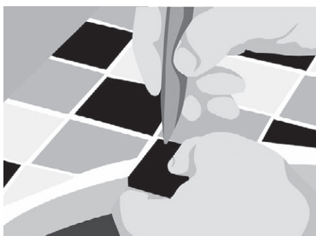
Рис. 5.98. Укладываем в случае необходимости небольшой уголок плитки
