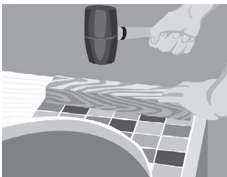
Рис. 5.95. Простукиваем мозаику резиновым молотком через деревянную планку
