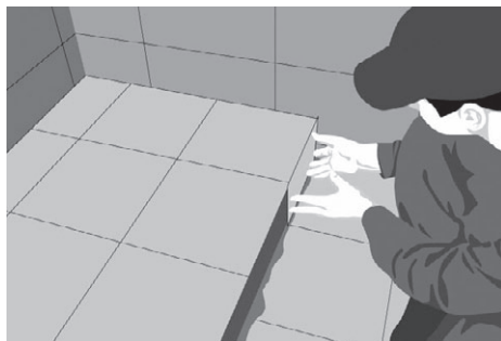
Рис. 5.76. Укладываем плитку на подступенок
