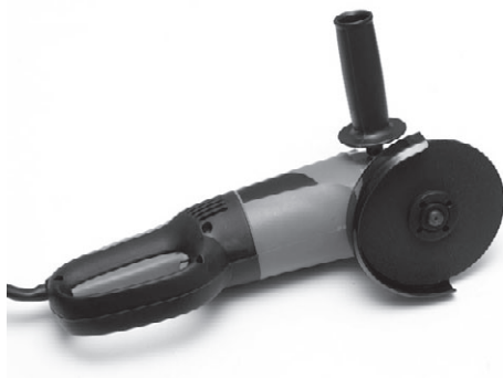
Рис. 5.124. Шлифовальная машинка, или болгарка
