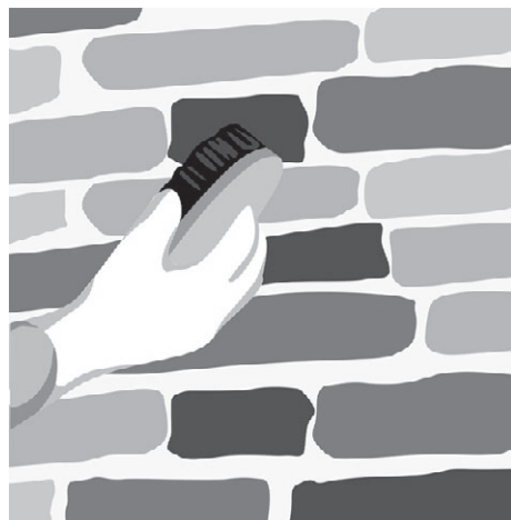
Рис. 8.24. Убираем жесткой щеткой излишки затирки
