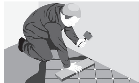
Рис. 5.32. Простукиваем плитки молотком
