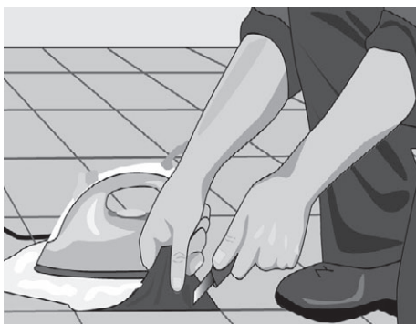
Рис. 9.44. Разогреваем старую плитку и мастику
