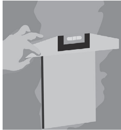
Рис. 4.51. Установка промежуточных маяков
