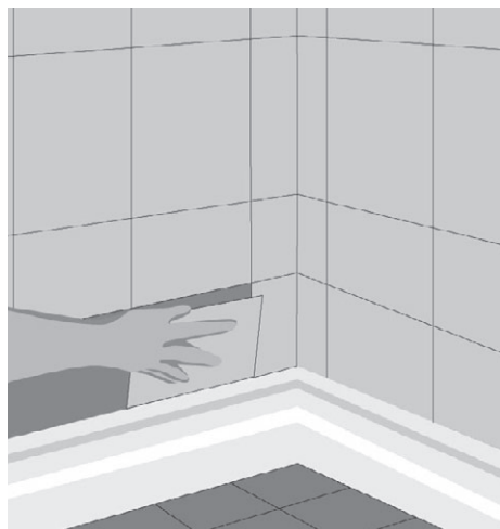
Рис. 5.54. Укладываем нижний ряд плитки
