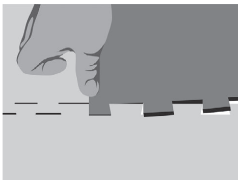
Рис. 9.29. Состыковываем угловой элемент замка половицы
