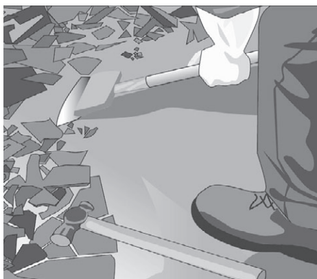
Рис. 4.3. Убираем осколки старой плитки
