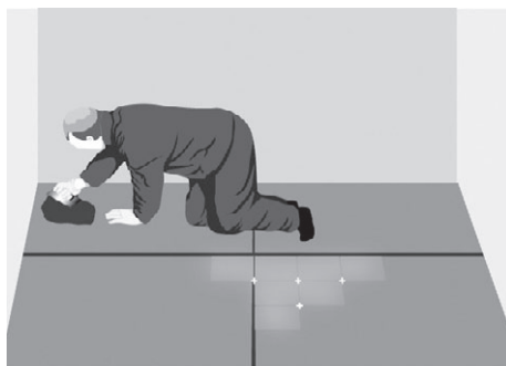
Рис. 5.25. Наносим клеевой раствор, начиная с дальнего угла от входа, двигаясь от центральной линии
