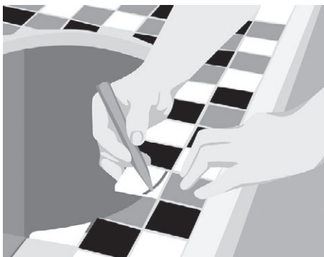
Рис. 5.91. Примеряем листы плитки, помечаем карандашом место разреза
