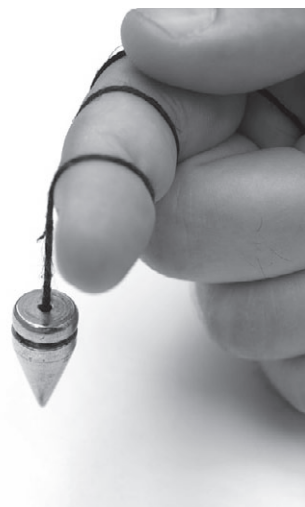
Рис. 4.48. Инструмент для провешивания — весок
