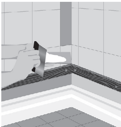
Рис. 5.53. Укладываем разрезанную плитку
