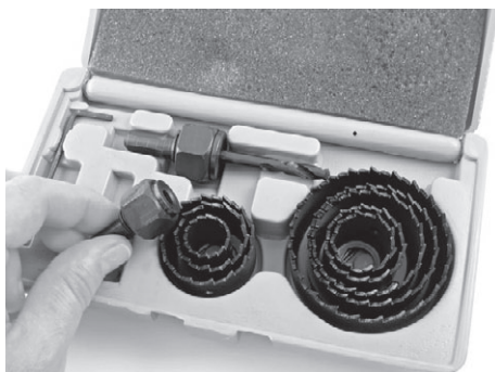
Рис. 5.131. Различные комплектующие кольцевой пилы для вырезания отверстий различного диаметра
