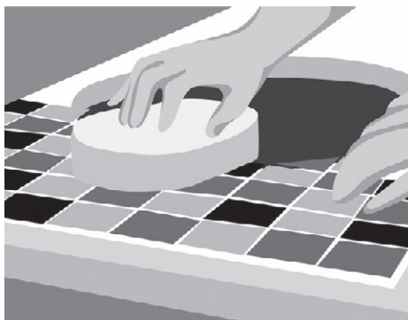
Рис. 5.96. Проглаживаем уложенную мозаику чистой губкой, чтобы убрать остатки клея
