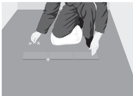
Рис. 5.24. Делаем сухую верстку плитки, выкладывая ее вдоль натянутого шнура через разделительные крестики
