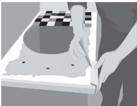
Рис. 5.90. Отмеряем от прямой планки с помощью карандаша и линейки место расположения мозаики
