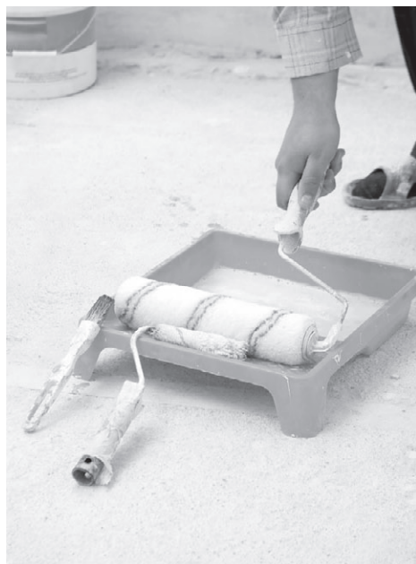
Рис. 4.40. Грунтовку можно нанести с помощью валика
