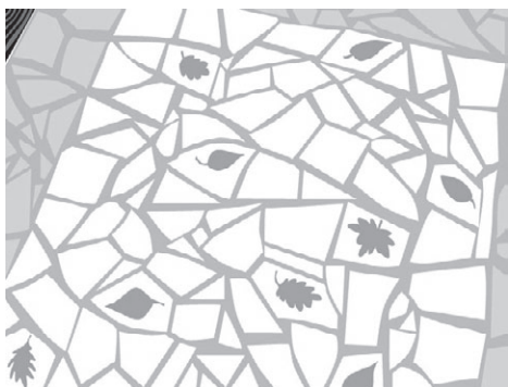
Рис. 5.139. Заделываем швы затиркой, на некоторые белые осколки наносим по трафарету рисунок из золотистых листьев
