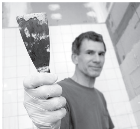
Рис. 5.84. Выровнять расстояние между листами мозаики поможет тонкий малярный шпатель
