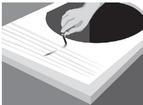
Рис. 5.92. Наносим клей на поверхность столешницы с помощью шпателя
