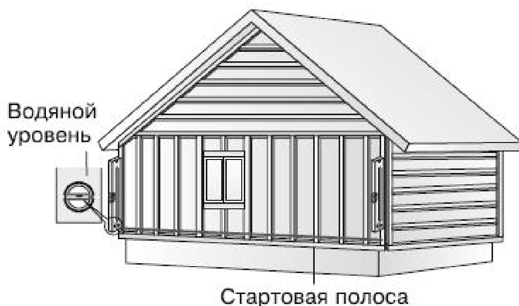
Рис. 4.4. Монтаж стартовой полосы
