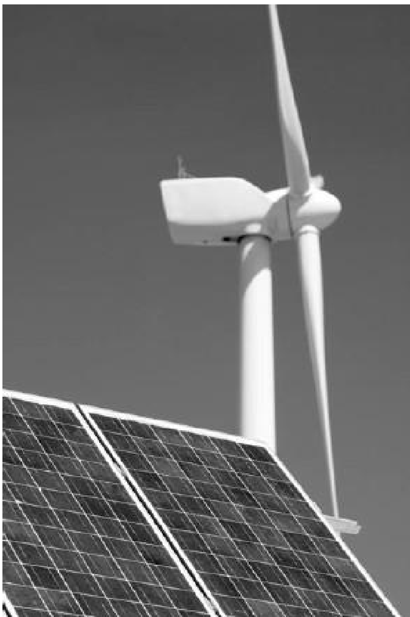
Рис. 1.18. Комбинированная система, состоящая из ветрогенератора и солнечных батарей
