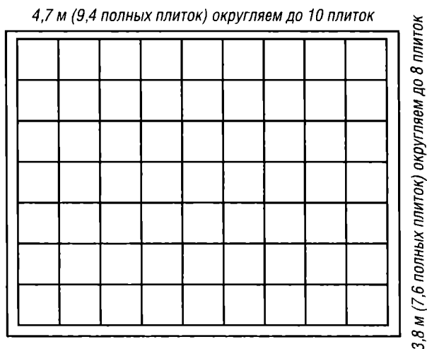
Рис. 9. Простейший вариант расположения плитки на потолке
