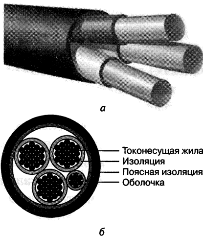
Рис. 4.6. Кабель ВВГнг: а — внешний вид; б — устройство
