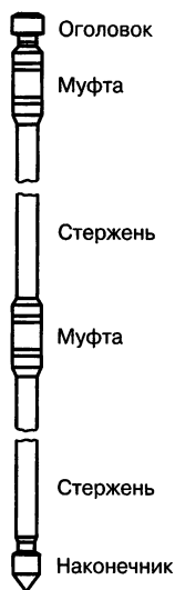
Рис. 4.11. Конструкция стержня модульно-штыревого глубинного заземлителя
