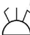
Блок из двух выключателей и одной розетки для открытой ус- тановки, IP20-IP23
