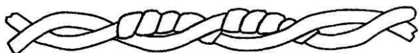
Рис. 1.25. Изолирование соединений проводов двухпроводного шнура. После изоляции каждого провода, изолируют оба провода вместе
