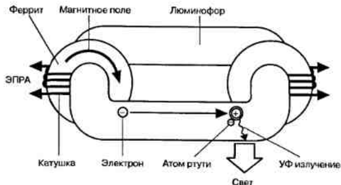
Рис. 1.32. Строение лампы ENDURA®
