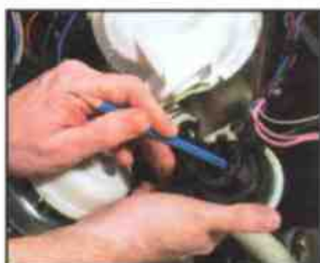
4 Проверьте свободное вращение крыльчатки насоса
