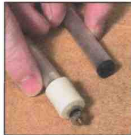
Два типа стекланных нагревательных элементов
