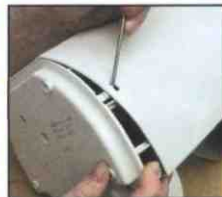
Пластиковые защелки отсоединяйте с помощью кончика отвертки
