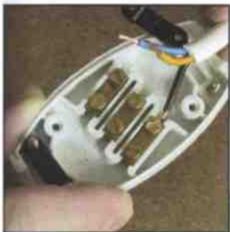
2 Вставьте оголенные концы жил в клеммы
