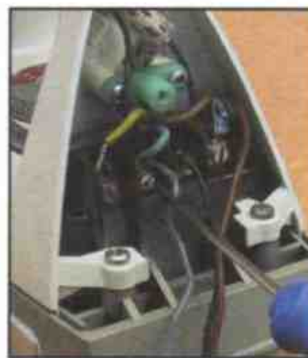
Перед отсоединением проводов пометьте их расположение
