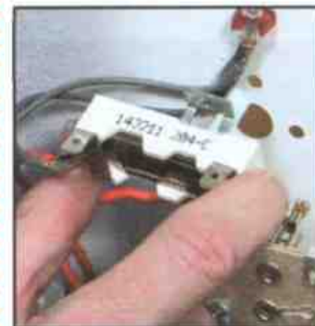
4 Замените неисправный терморегулятор
