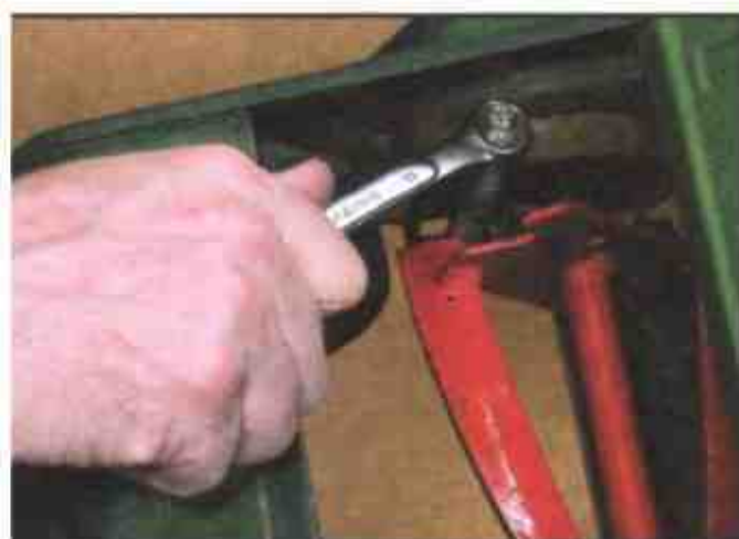
Отрегулируйте зазор между ножами
