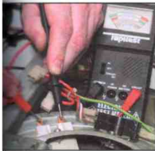
Пусть специалист проверит и заменит неисправный термopедохранитель
