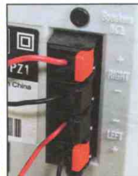
Фазность этих колонок нарушена
