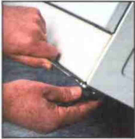
Отрегулируйте положение ножек
