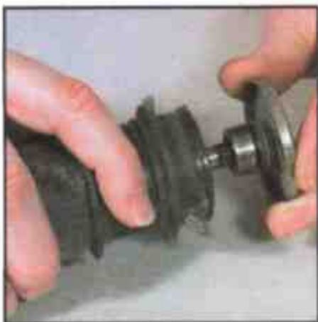
1 Выдвиньте металлический вал
