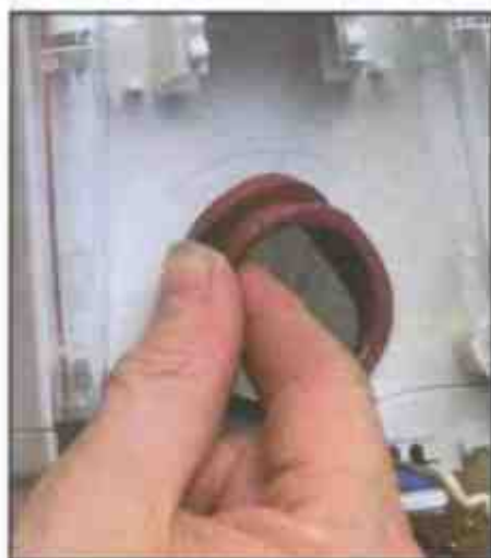
Замените поврежденную прокладку
