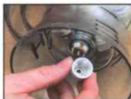
2 Фиксирующая гайка находится внутри
