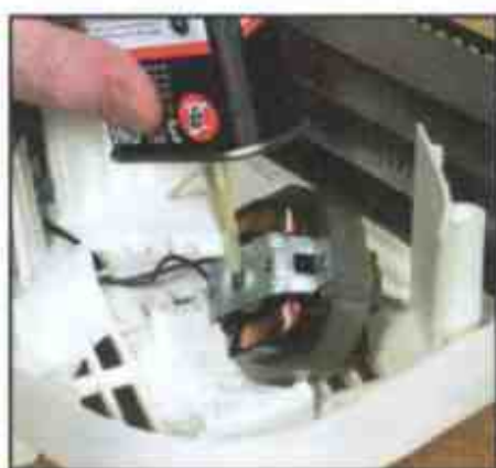
4 Смажьте также и нижний подшипник
