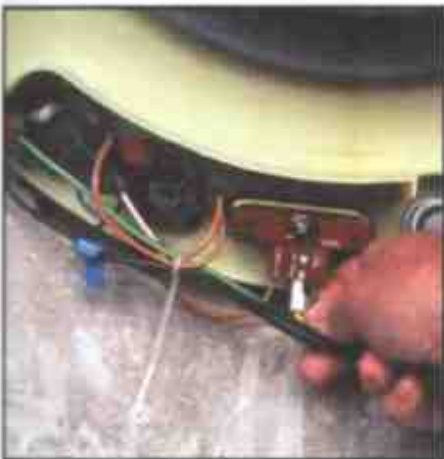
1 Проверьте состояние контактов
