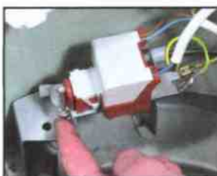
Проверьте работу выключателя механически
