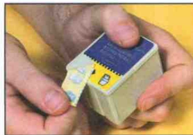
Не забудьте снять защитную наклейку
