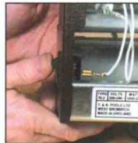
1 Выключатель должен издавать слышимые щелчки
