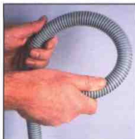
Проверьте шланг на наличие трещин
