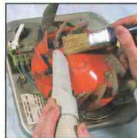
3 Очистите от пыли крыльчатку
