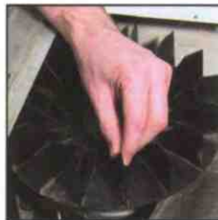
Проверьте, вращается ли барабан, если вращать крыльчатку вентилятора
