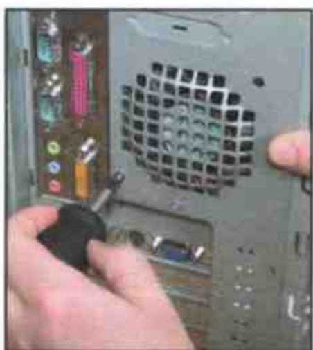
2 Отверните крепеж шумного вентилятора
