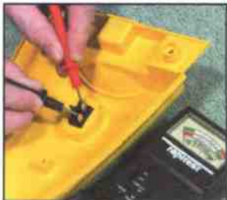
3 Проверьте исправность выключателя
