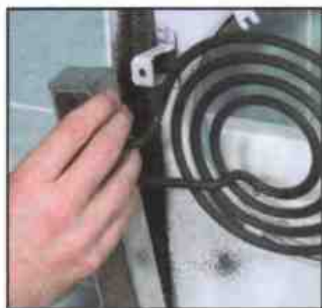
3 Снимите монтажную планку
