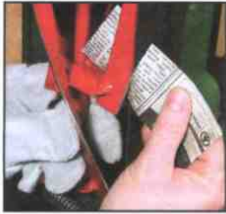
Вращайте цилиндр, чтобы разрезать бумагу
