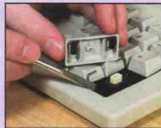
3 Не забудьте зафиксировать большие клавиши держателями
