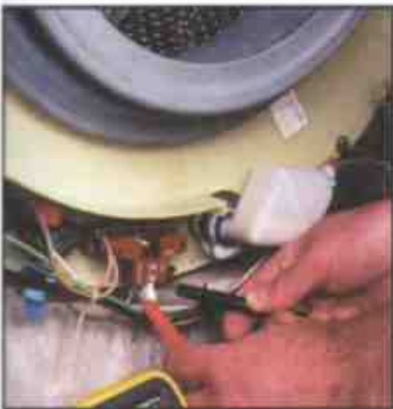
2 Коснитесь контактов щупами тестера
