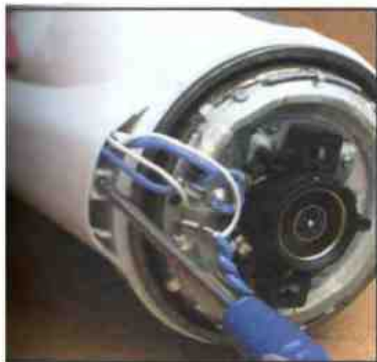
2 Отверните все крепежные винты в основании ручки
