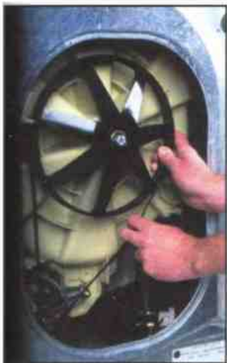
Наденьте приводной ремень на шкив (если кромки острые, работайте в перчатках)
