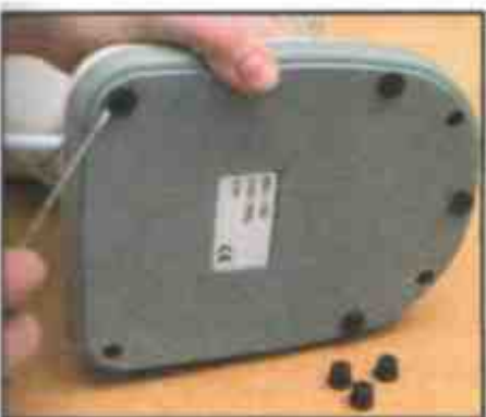
Резинки закрывают крепежные винты
