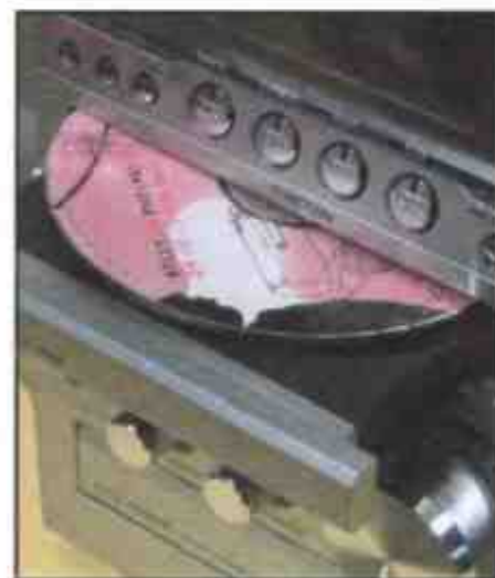
Неправильно вставленный диск может заклинить лоток плеера компакт-дисков
