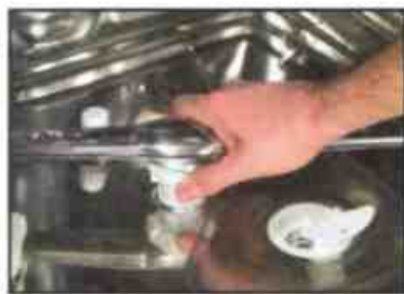
1 Отвинтите гайку с накаткой и снимите нижнюю крыльчатку
