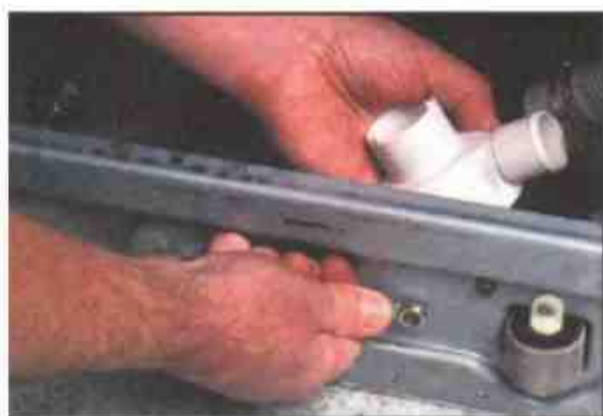
2 Отверните крепежные болты насоса
