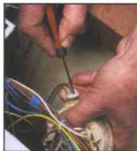
4 Демонтируйте и замените неисправный выключатель регулятора уровня воды
