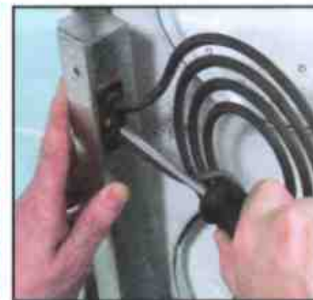
6 Отверните винт крепления накладки
