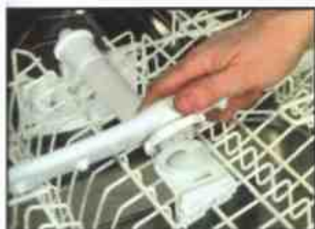
2 Выдвиньте корзину, для того чтобы отсоединить верхнюю крыльчатку
