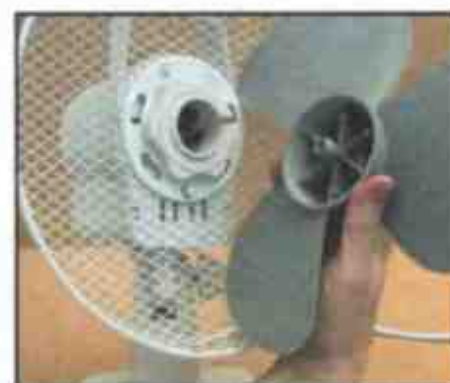
2 Снимите пропеллер с вала
