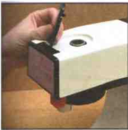
Снимите небольшую пластмассовую крышку привода соковыжималки
