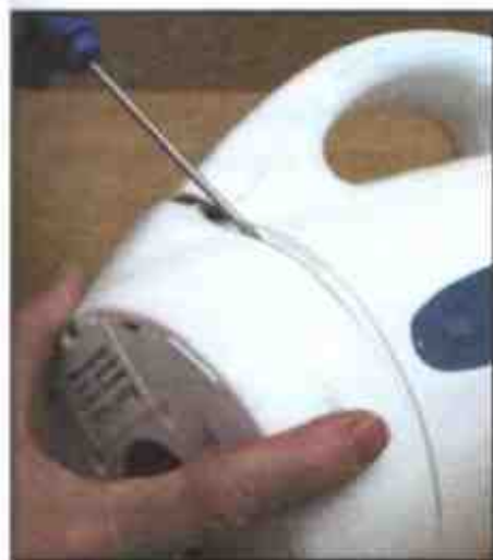
1 Аккуратно снимите крышку основания
