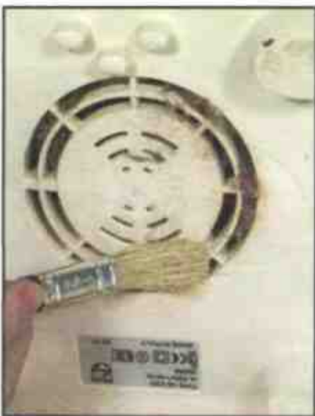
Сметите пыль и пух с вентиляторных отверстий
