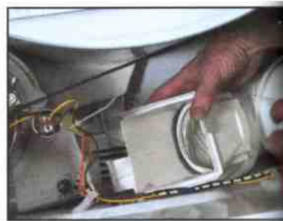
Некоторые воздуховодные шланги отсоединяются изнутри
