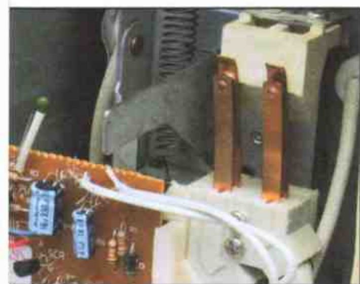
При включенных защелках контакты выключателя должны касаться друг друга
