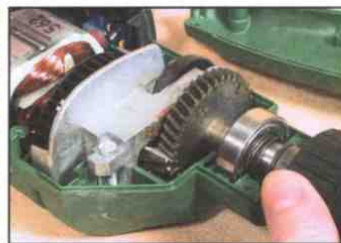
1 Посмотрите, нет ли повреждений в редукторе
