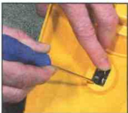
4 Чтобы снять выключатель, отожмите защелки
