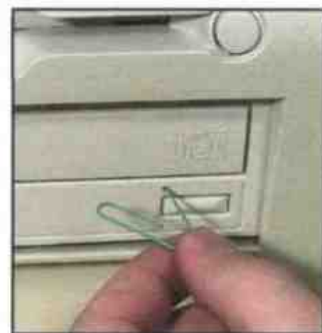
Или откройте замок с помощью распрямленной канцелярской скрепки
