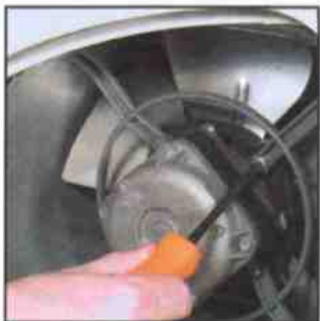
Затяните винты крепления электродвигателя
