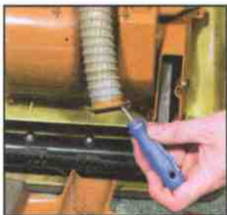
Воздуховодом может быть и гибкий шланг
