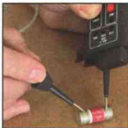
Проверьте пробником подозрительный предохранитель
