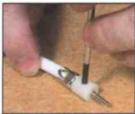
7 Затяните крепежный винт
