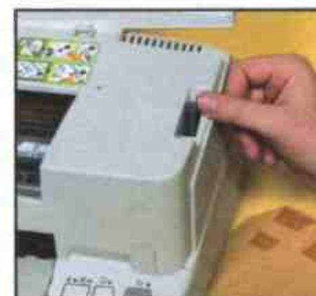
1 Отрегулируйте рычаг регулировки толщины бумаги
