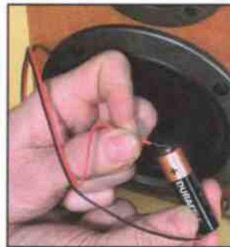
Для проверки колонки воспользуйтесь батареей
