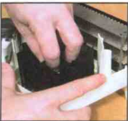
1 Снимите крыльчатку с оси
