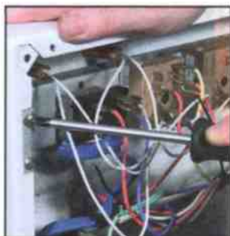
7 Отверните крепеж монтажной планки переключателей
