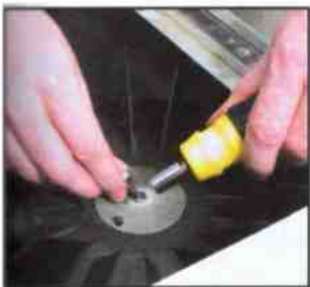
Снимите крыльчатку и почистите электродвигатель
