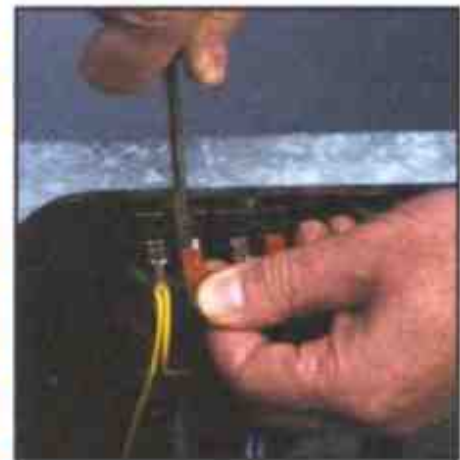
Тугие наконечники контактов снимайте отверткой
