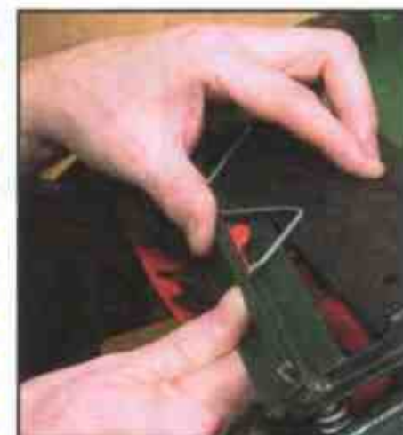
2 Закрепите заточное устройство на неподвижном ноже
