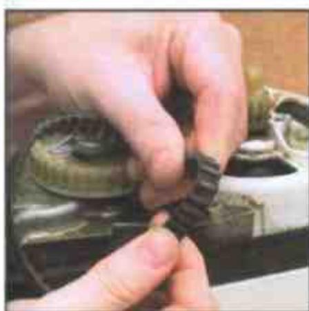
3 Проверьте на ремне наличие трещин
