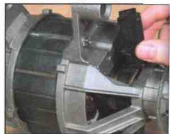
3 Выньте и замените блок щеток
