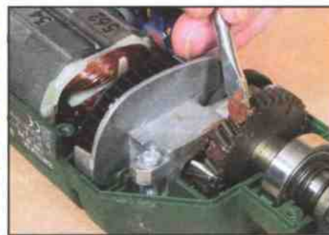
2 Перераспределите заводскую смазку
