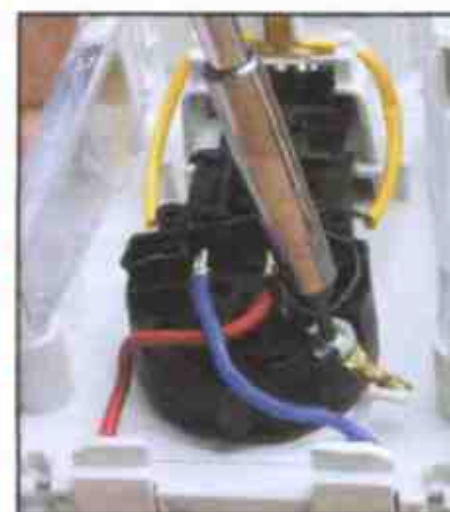
Затяните крепежные винты нагревательного элемента
