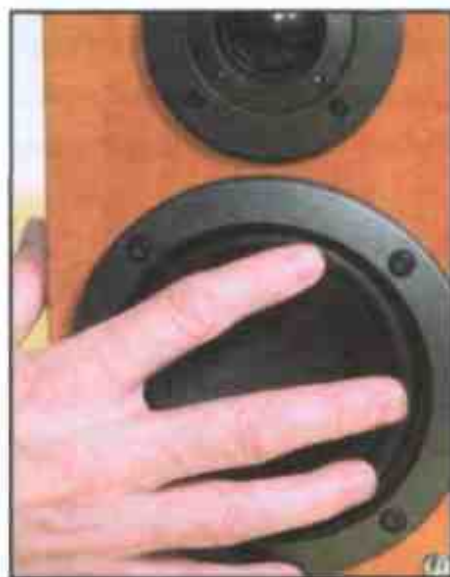
Проверьте, нет ли трещин или разрывов в диффузорах динамиков колонок
