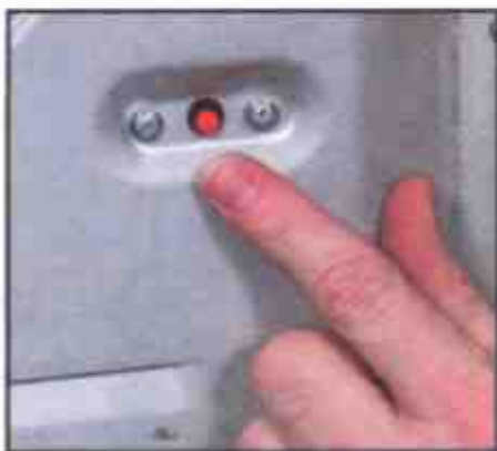
У машины может иметься кнопка сброса тепловой защиты
