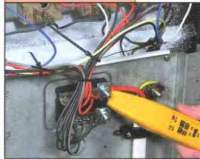
Поднесите бесконтактный тестер к клеммной колодке
