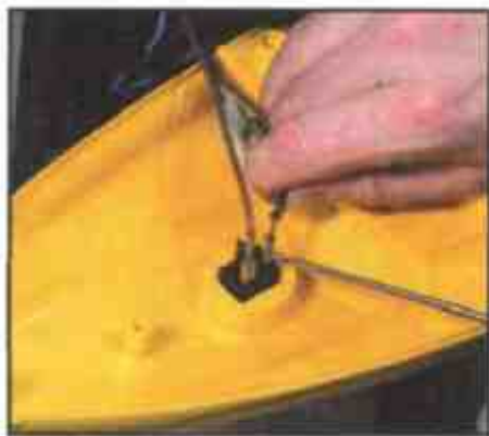
2 Снимите наконечники проводов с контактов
