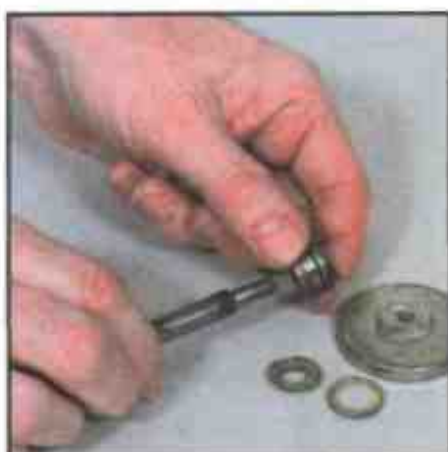
3 Снимите изношенные подшипники
