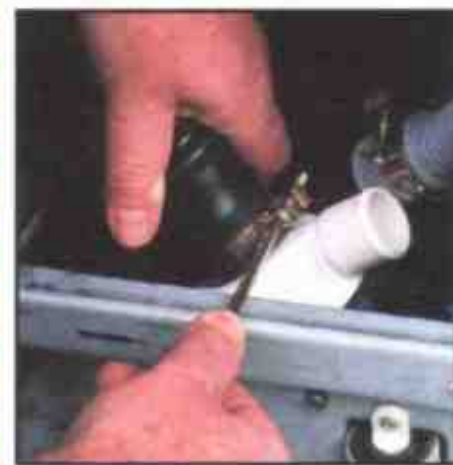
4 Установите прочищенный насос на место
