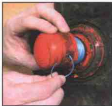
2 Поставьте на место крышку корпуса катушки
