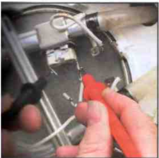
2 Затем коснитесь щупами тестера контактов термостата
