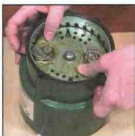
3 Проверьте надежность крепления диска
