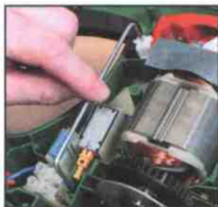
1 Снимите рычаг выключателей
