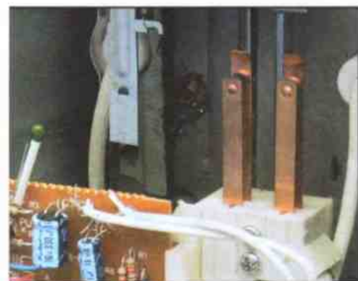
Металлические пластинчатые контакты выключателя должны быть чистыми
