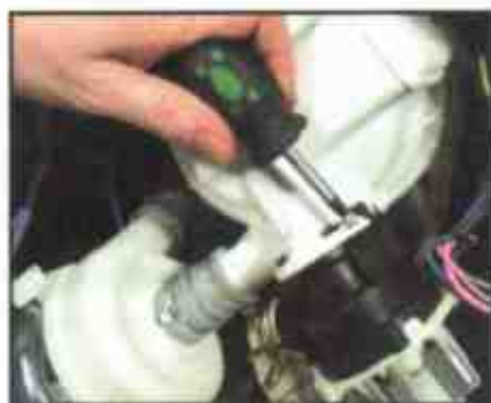
1 Отверните все крепежные винты
