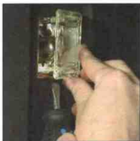
Прямоугольный плафон подденьте отверткой
