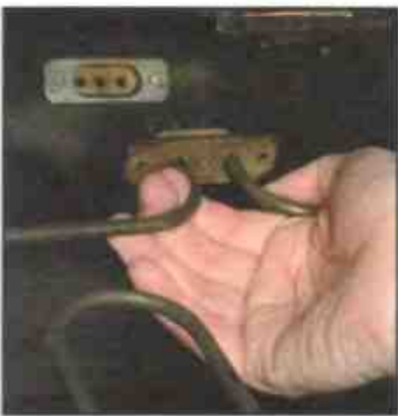
1 Выньте элемент из его контактной колодки
