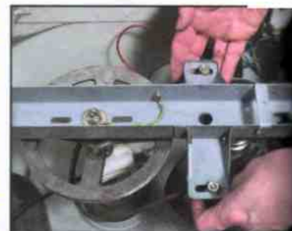
1 Отодвиньте электродвигатель от шкива
