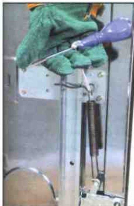
1 Натяните и отсоедините пружины
