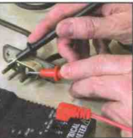
2 Проверьте ТЭН на обрыв
