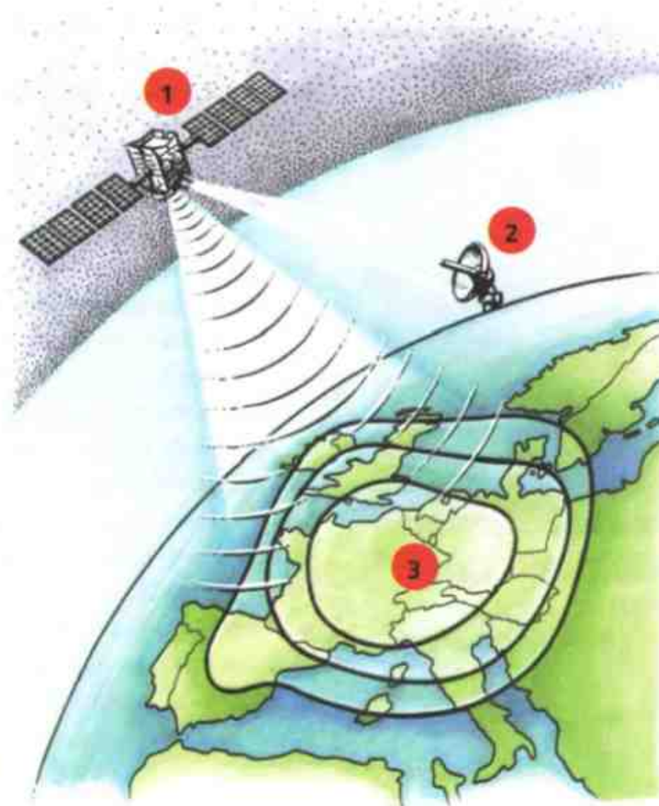
1 Спутник на геостационарной орбите 2 Наземный передатчик 3 Зона обслуживания
