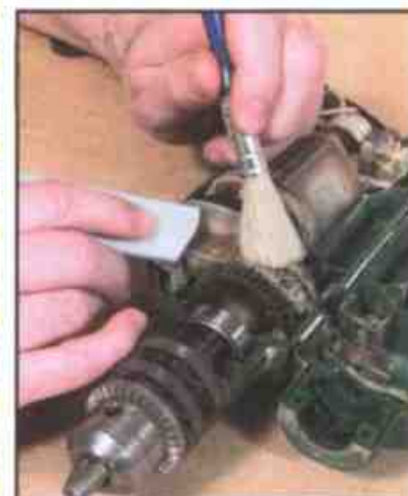
Удалите пыль с крыльчатки
