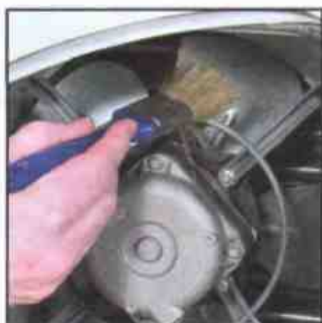
Грязный вентилятор может быть разбалансирован
