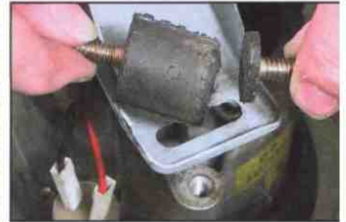
1 Отверните обе шпильки
