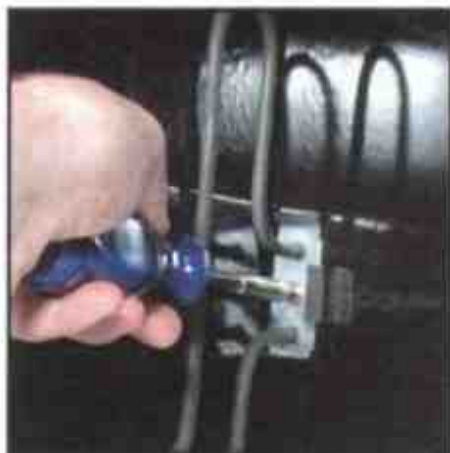
2 Выверните крепежный винт ТЭНа
