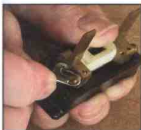
2 Намотайте на клемму проволоку
