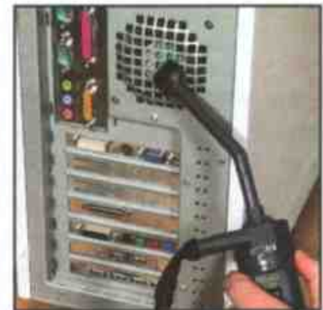
Вентиляционные решетки чистите пылесосом
