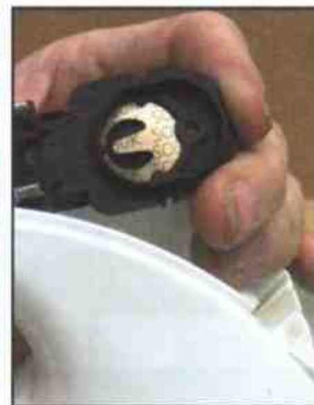
8 Осмотрите биметаллическую пластину – нет ли видимых дефектов
