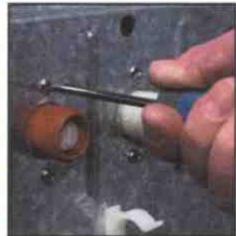
Открутите винты и снимите впускные клапаны
