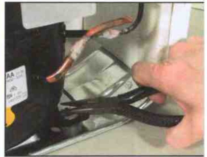
От вибрации опоры компрессора могут разболтаться
