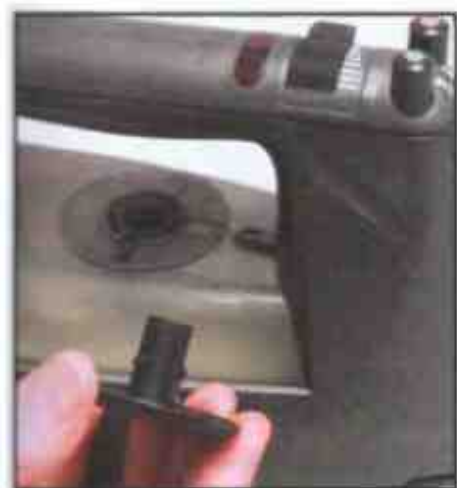
1 Некоторые ручки терморегулятора имеют встроенные зажимы
