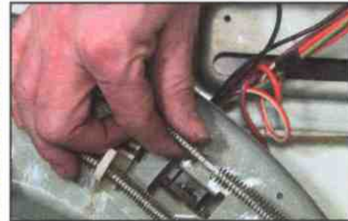
Спираль нагревательного элемента может быть оборвана
