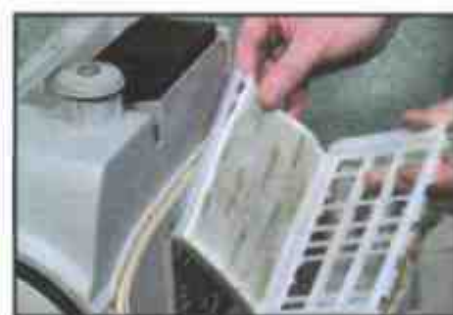
Замените фильтр пылезащиты электродвигателя
