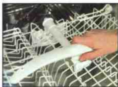
2 Выдвиньте корзину, для того чтобы отсоединить верхнюю крыльчатку
