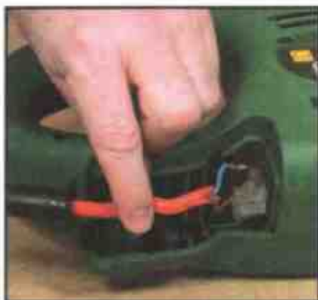
2 Отсоедините поврежденный шнур
