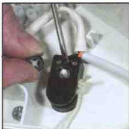
Подденьте и снимите фиксирующую шайбу
