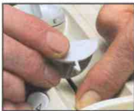
Расширьте прорезь, чтобы освободить ручку с зацеплением
