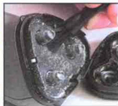
Снимите блок ножевых головок и почистите щеткой
