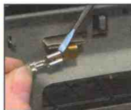
Снимите наконечники с контактов
