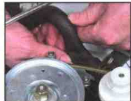
В поиске трещин осмотрите шланг с разных сторон
