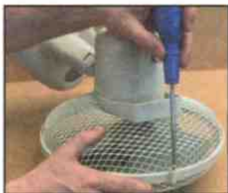
1 Отверните винт крепления ограждения
