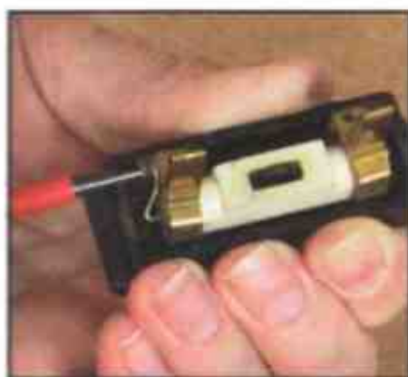
1 Ослабьте винт клеммы
