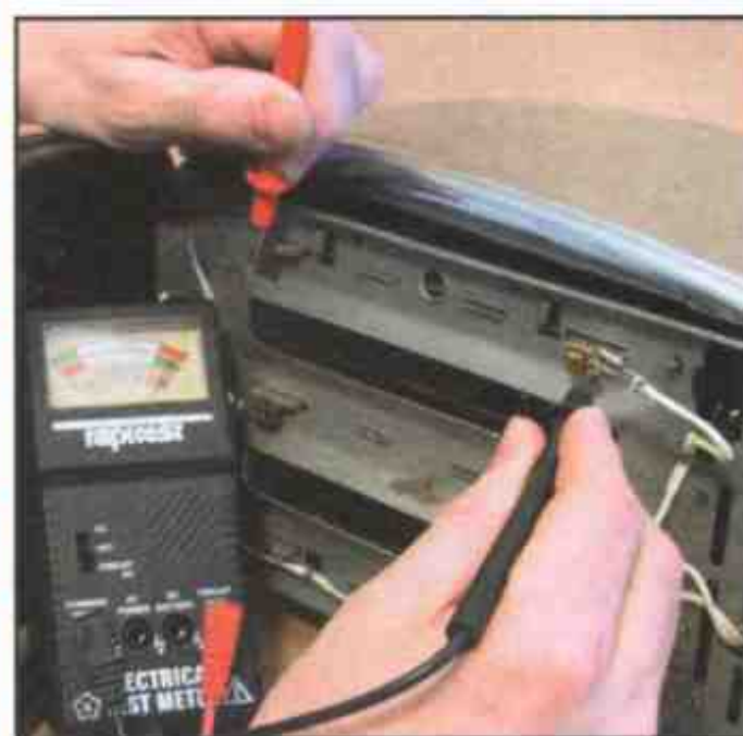
Проверьте нагревательный элемент тестером
