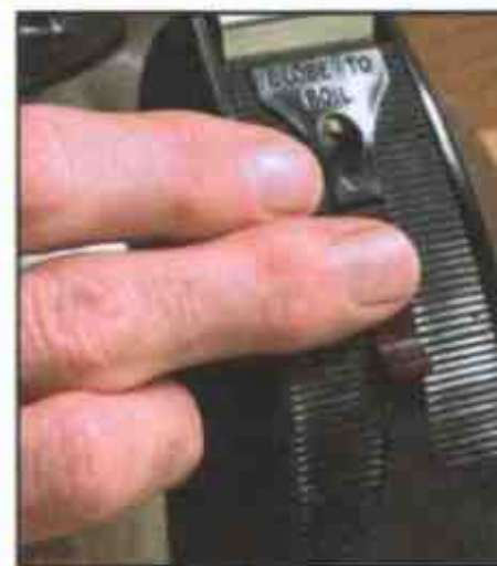
Изношенный выключатель может не фиксироваться во включенном положении
