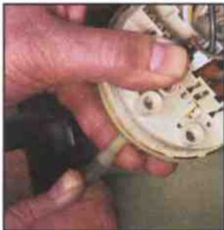
1 Обрежьте затвердевший конец трубки и подсоедините ее к выключателю
