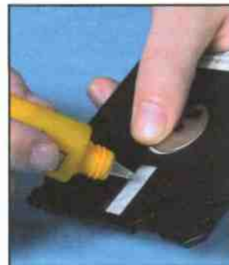
Чистите дисковод для дискет раз в месяц с использованием специальной дискеты с чистящей жидкостью
