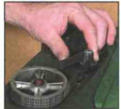
5 Нажмите на ремень для проверки натяжения
