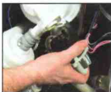
2 Снимите водоотливной насос
