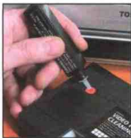
1 Увлажните ленту чистящей жидкостью
