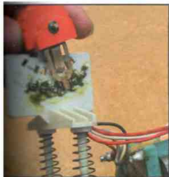
Почистите контакты выключателя, но оставьте смазку
