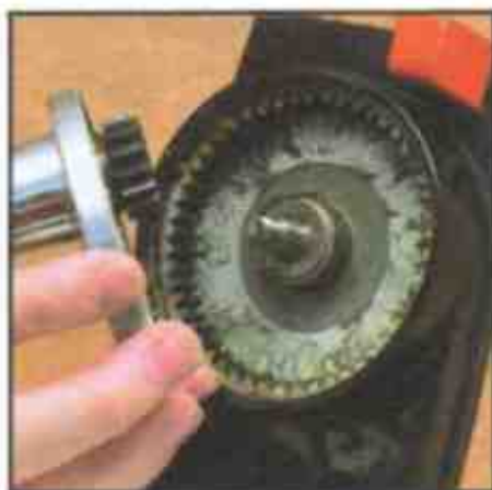
1 Отверните гайку и снимите крышку
