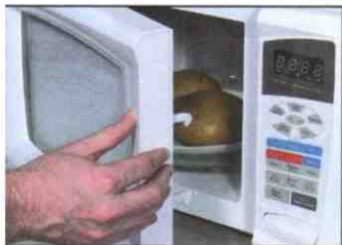
Проверьте работу защелки
