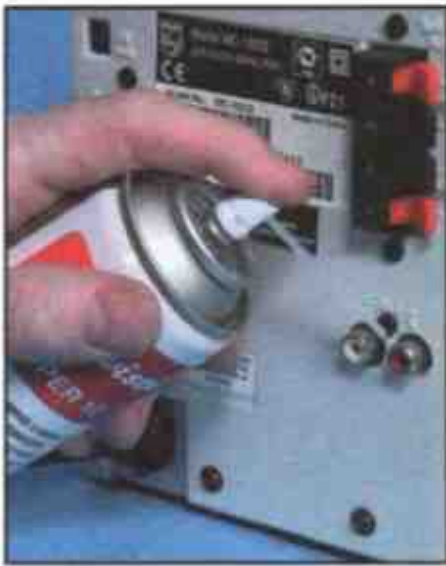
Обработайте все соединительные элементы жидкостью-антиоксидантом
