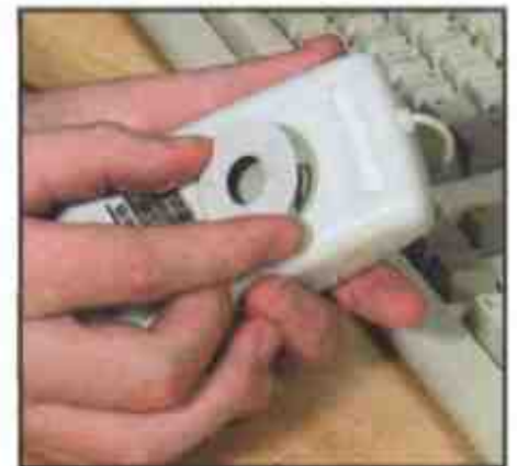
1 Снимите фиксирующее кольцо шарика
