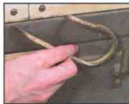
Замените испортившиеся прокладки задней панели
