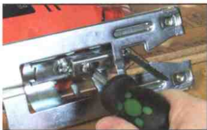
Отрегулируйте опорный ролик
