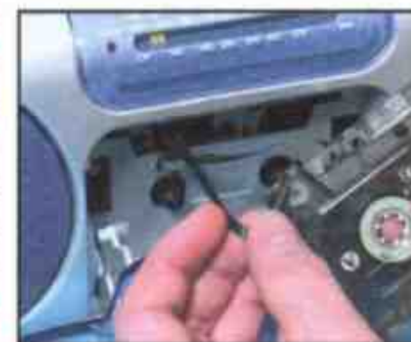
Лента может запутаться в лентопротяжном механизме
