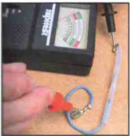
Прозвоните тепловой предохранитель тестером
