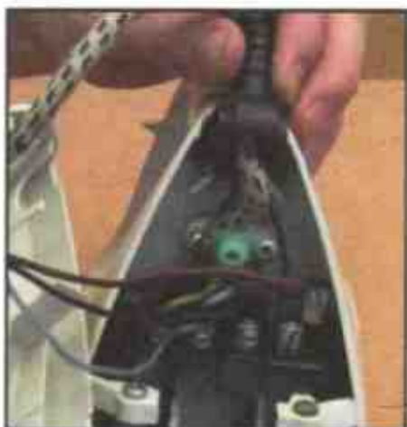
За открытой крышкой расположена контактная колодка
