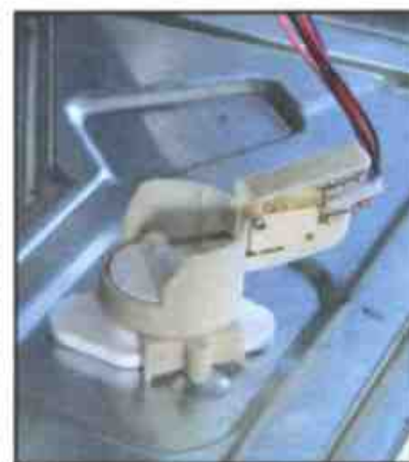
Поплавковый выключатель защиты от перелива и протечек
