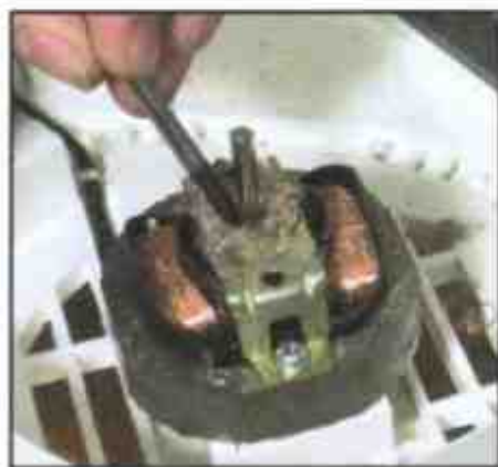
2 Удалите пух с подшипника двигателя
