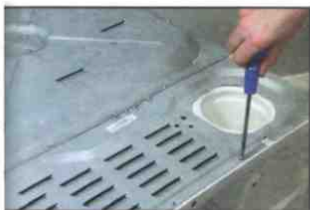
Панели корпуса фиксируются с помощью резьбового крепежа
