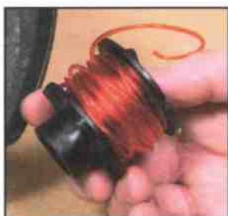
Плохо намотанную катушку может заклинить
