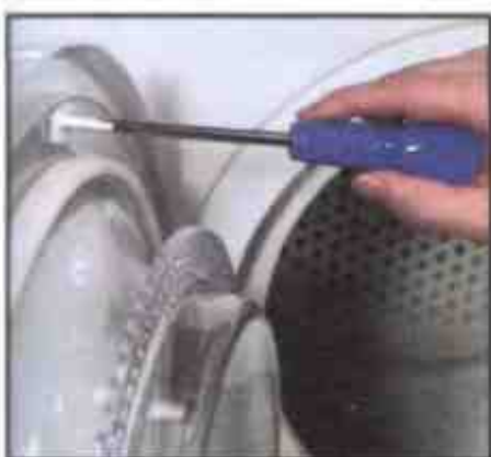
Приверните новый шток выключателя дверцы
