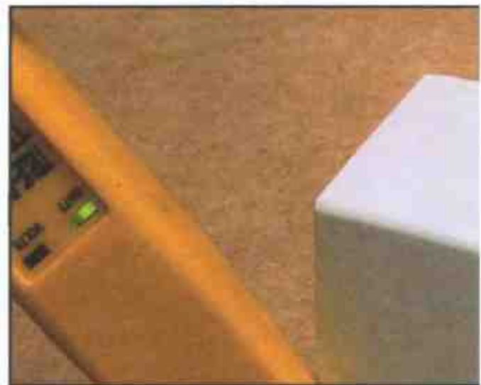
Поднесите бесконтактный тестер к базовому выступу
