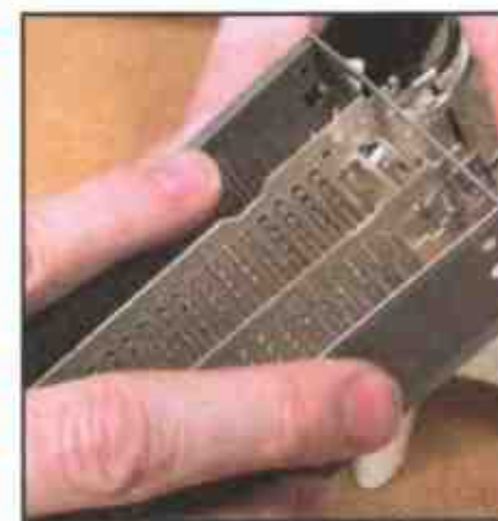
Визуально поищите обрыв в нагревательном элементе
