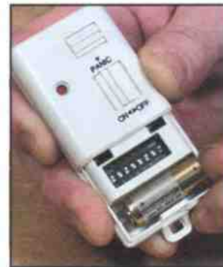
Соблюдена ли полярность подключения батареи?
