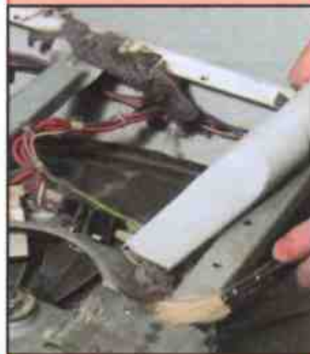
При любой возможности удаляйте пыль с внутренних деталей машины
