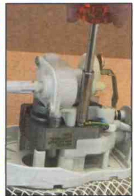
Затяните соединения заземления
