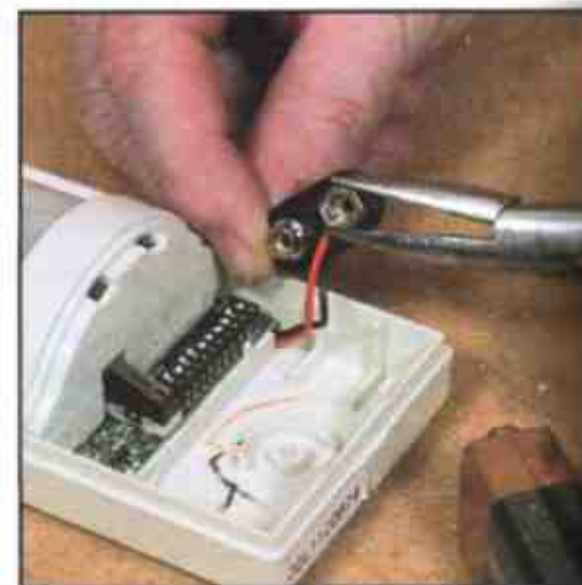
Устраните деформацию контактов
