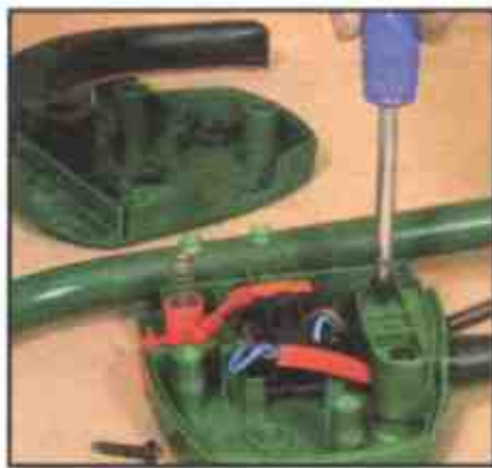
2 Отвинтите прижимную планку шнура
