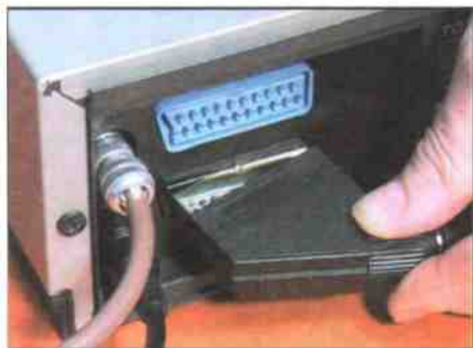
Проверьте все соединительные кабели, включая кабели с разъемами SKART
