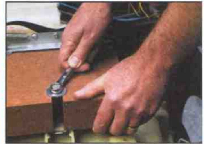
Затяните болты балласта
