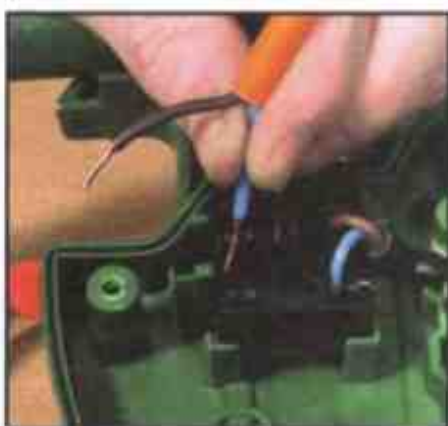
4 Вставьте жилу шнура в клемму
