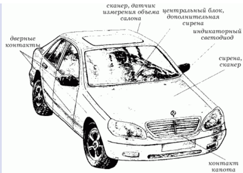
Рис. 128. Расположение блоков и датчиков в автомобиле.
