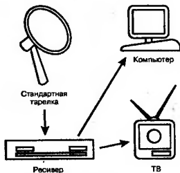
Рис. 7.2. Схема подключения к спутниковому Internet с использованием стандартного конвертера
