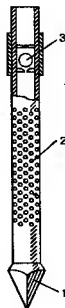
Рис. 3.6. Конструкция простейшего фильтра абиссинского колодца: 1 — копьевидный наконечник; 2 — труба с отверстиями; 3 — шариковый клапан
