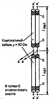
Рис. 6.5. Схема соединения двухэтажной телеантенны типа «Двойной квадрат»
