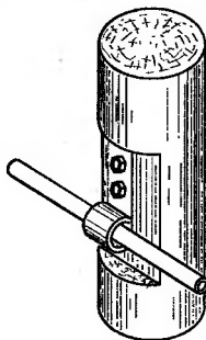
Рис. 1.36. Вариант конструкции самодельного подшипника ротора
