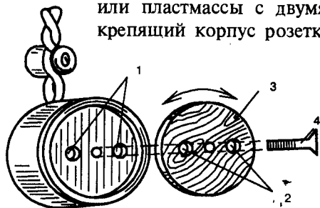
Рис. 1.66. Конструкция безопасной розетки:
