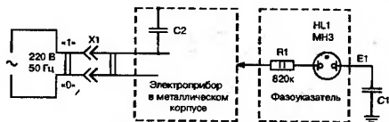
Рис. 1.114. Методика определения фазировки сетевой розетки и вилки бытового прибора
